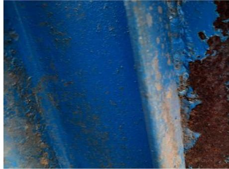
Figura 2.9 Corrosión por picaduras en TR1 LaGeo, Berlín.
