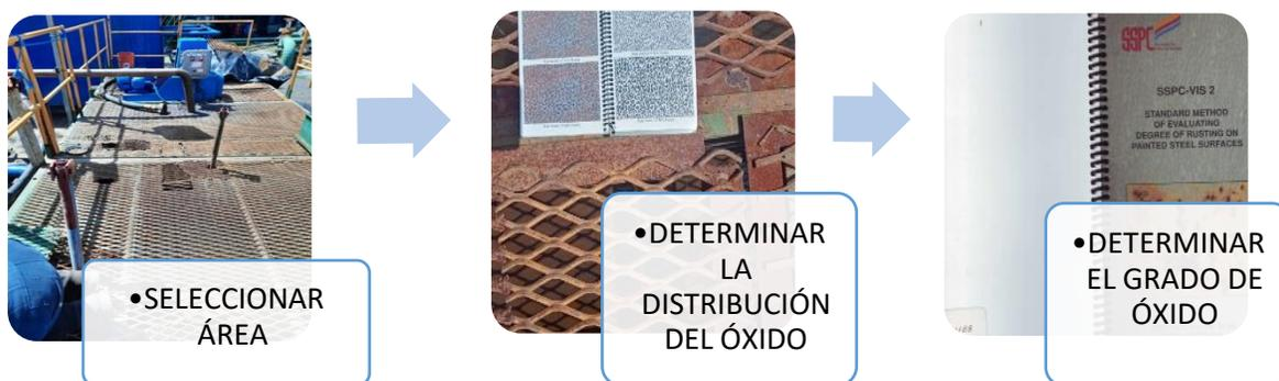
Figura 3.1 Pasos para aplicación de Guía SSPC-VIS 2.
