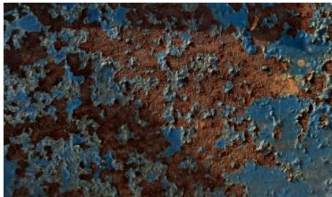
Figura 2.8 Corrosión generalizada en TR1 LaGeo, Berlín.
