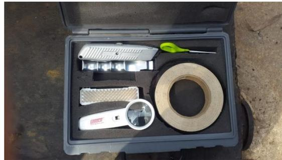
Figura 3.6 Equipo certificado de pruebas de adhesión.
