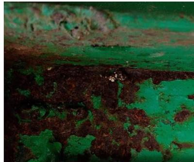
Figura 2.10 Corrosión por esfuerzo en TR1 LaGeo, Berlín.
