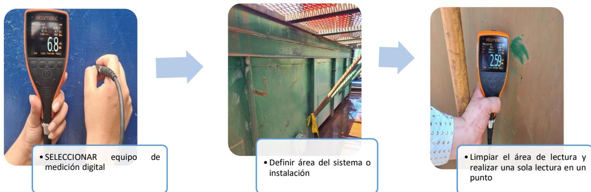
Figura 3.2 Pasos para aplicación de Guía SSPC-PA 2.
