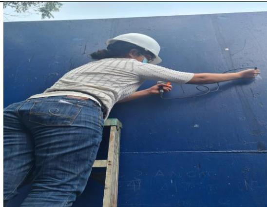
b) Medición de E.P.S. en tanque.
