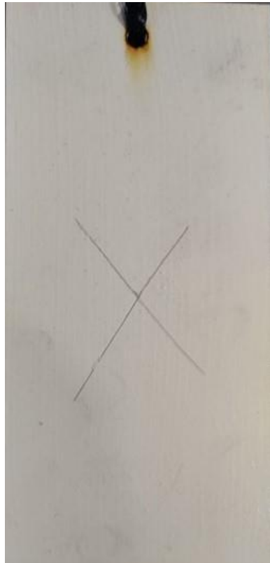
Figura 5.5: Daño concentrado en el centro de la marca, se puede notar el desprendimiento de una parte del recubrimiento cerca del corte.
