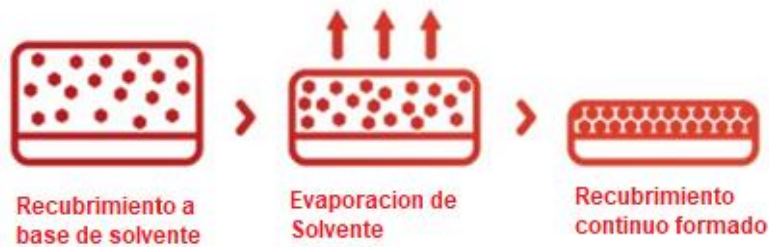
Figura 2.5: Mecanismo de secado/curado de un recubrimiento. (BASF Handbook Basics of Coating Technology, 2003)
