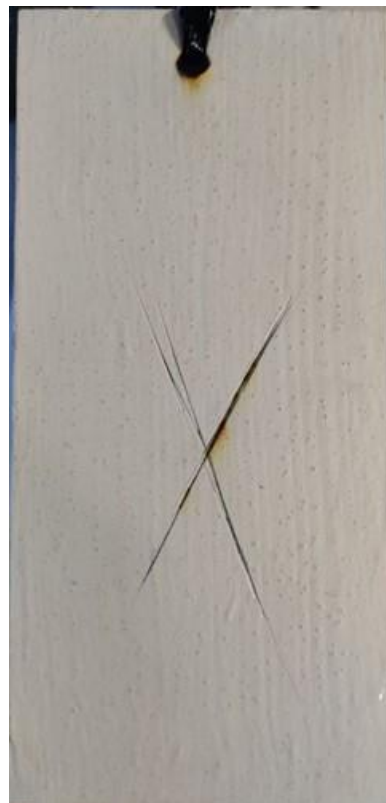
Figura 5.6: daño avanzado en las áreas de corte. Blistering generalizado en los alrededores del corte.
