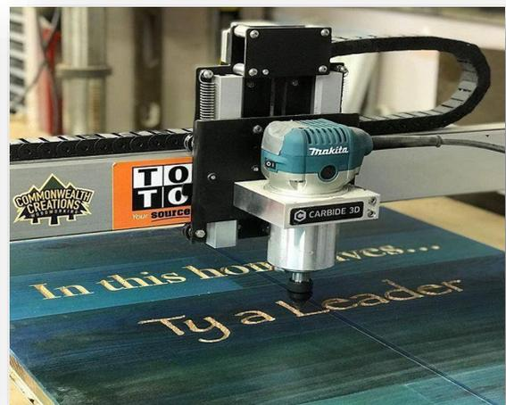
La cinta oramask se pega sobre la pieza y luego se realiza el mecanizado deseado, posteriormente se pasa a la etapa de pintado con la cual la cinta permite que solamente las áreas mecanizadas sean pintadas de forma inmediata. Luego solo se espera a que la pintura se seque para poder retirar la cinta y así obtener el acabado esperado.
