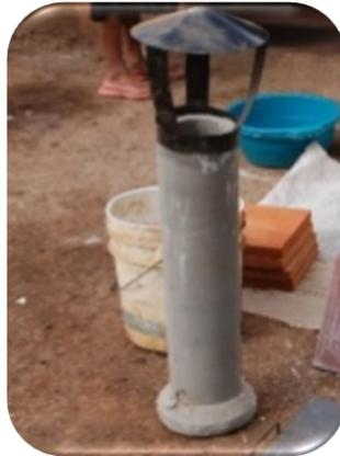
Figura 3. Chimenea y capacete de una cocina.
