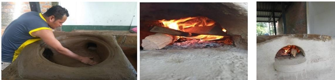
Figura 27. Pruebas de encendido en la cocina prototipo.
