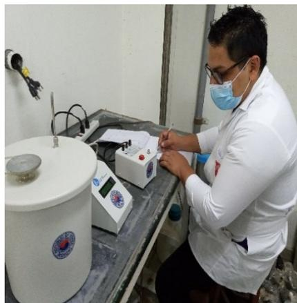
Figura 15. Determinación del poder calorífico de la leña con una bomba Calorimétrica.
