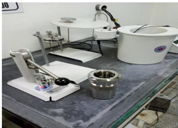
Figura 4. Bomba Calorimétrica modelo Parr 1341.
