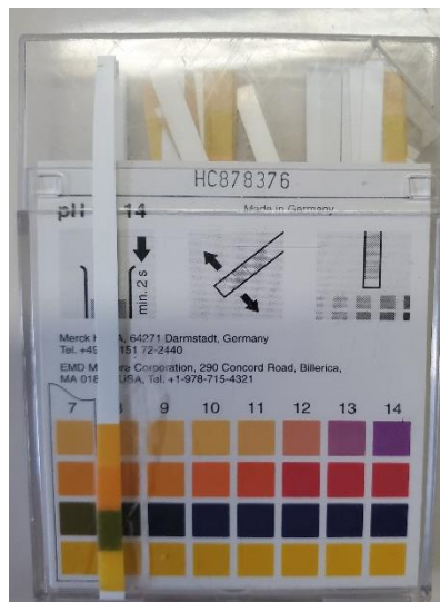
Figura N°16 Medición de pH mediante tira de papel pH en la estandarización de la formula seleccionada.
