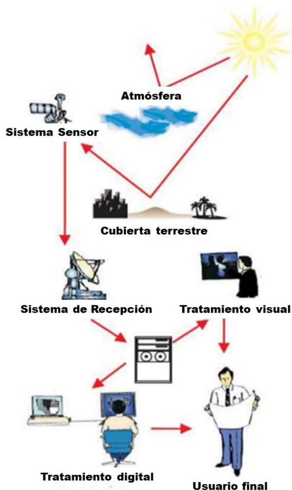
Figura 3. Elementos de la teledetección. Fuente: Chuvieco (1995).
