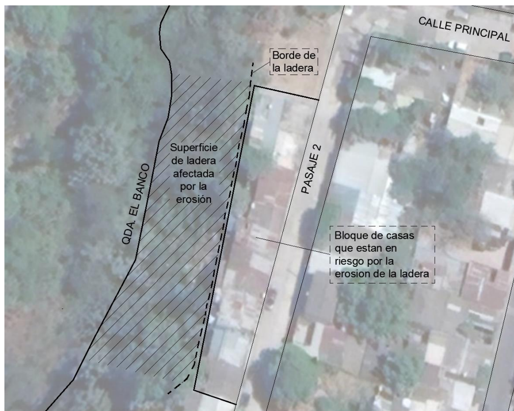
Imagen 3.8. Esquema de la superficie afectada por la erosión (mayo, 2021).
