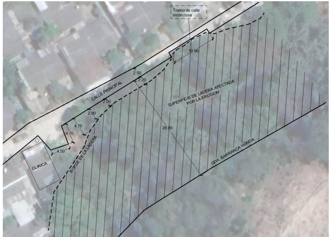
Imagen 3.3. Esquema de la superficie afectada por la erosión (mayo, 2021).
