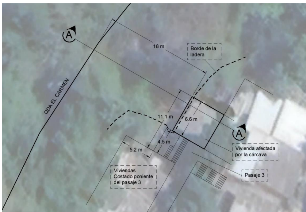
Imagen 3.14. Esquema de la formación de la cárcava, vista en planta (junio, 2021).
