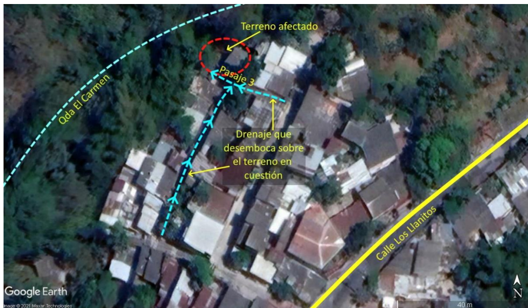
Imagen 3.11. Red de drenaje superficial que se está vertiendo sobre el terreno (junio, 2021).
