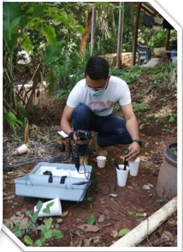
Anexo A7: Toma de mediciones mediante la sonda paramétrica en Guacotecti.
