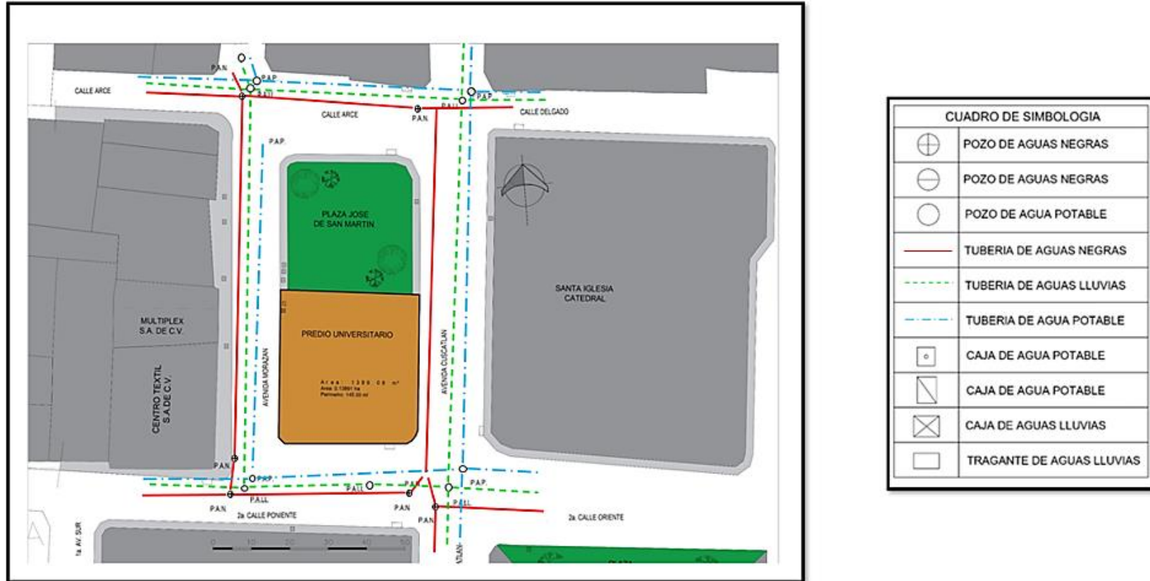
Plano 8. Sistema de Red Hidráulica
