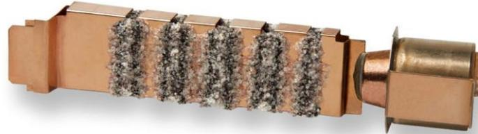
e) El material de relleno para extinción de arco ayuda a sofocar el arco eléctrico por fusión y formación de fulgurita
