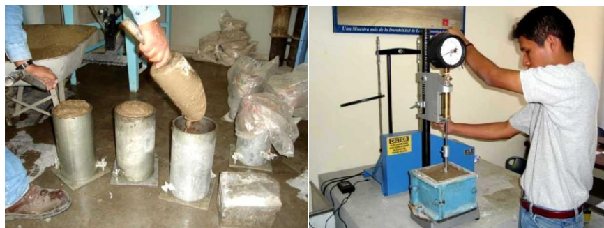
Fig. 4.4 Pruebas de Resistencia a Materiales de Resistencia baja Controlada
