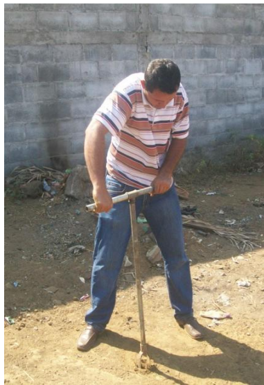
Fig. 3.1.1 Toma de Muestras con Barreno a diferentes profundidades
