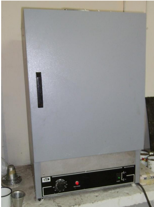
Fig. 3.4.4 Horno para el secado de las muestras calculando así su peso luego de haber perdido la humedad.
