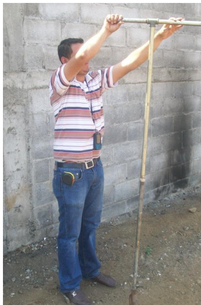
Fig. 3.1 Extracción de muestra de suelo con barreno helicoidal
