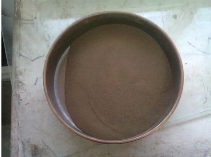
Fig. 3.5.2 Suelo fino a usar para la obtención de Límite Líquido y Límite Plástico
