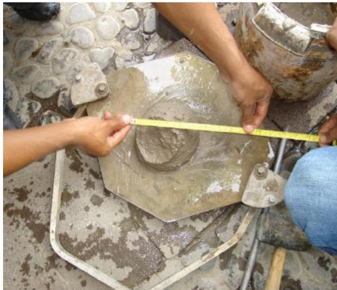
Fig. 2.7 Revenimiento de Suelo Cemento Fluido
