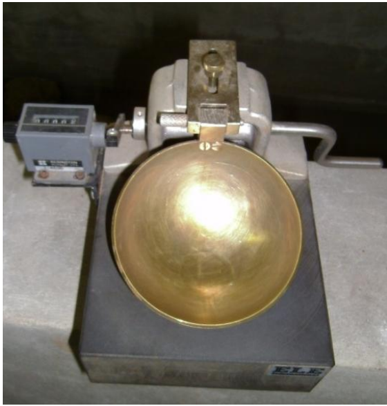
Fig. 3.4.1 Copa de Casagrande debidamente calibrada para la obtención del Límite Líquido.
