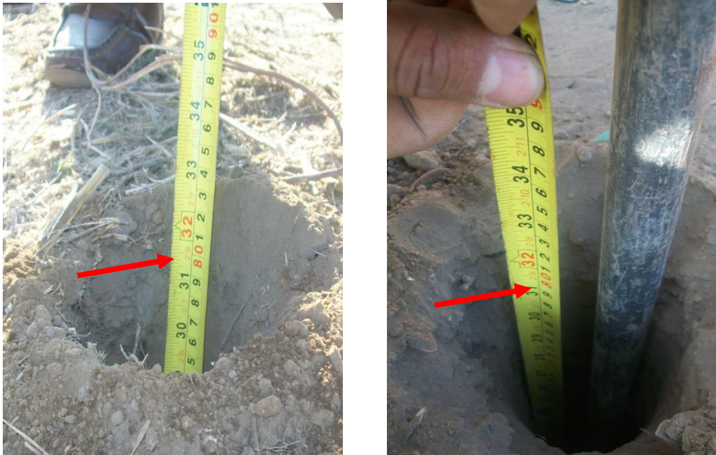
Fig. 3.2 Verificación de profundidad de Muestreo
