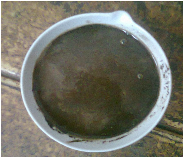
Fig. 3.5.3 Saturación de material que ha pasado la malla #40 para su respectivo análisis.
