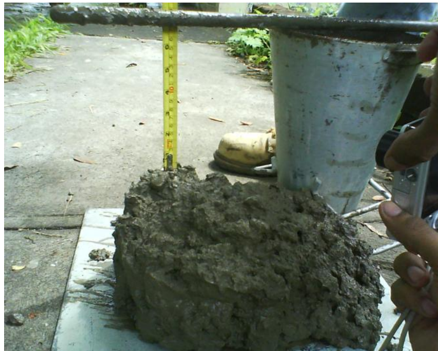
Imagen 3.10.6. Prueba de revenimiento para la mezcla de a/c de 0.6 usando agregado vítreo.
