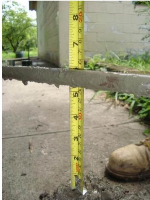
Imagen 3.10.4. Prueba de revenimiento para la mezcla de a/c de 0.5 usando agregado vítreo.
