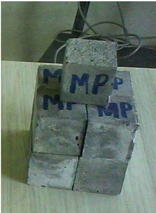
Imagen 4.3.3. Elementos de Mortero Tipo "M" con agregado Pétreo.
