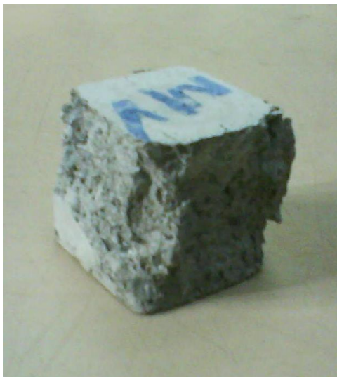
Imagen 4.3.7. Tipo de Falla en un Espécimen de mortero Vítreo.
