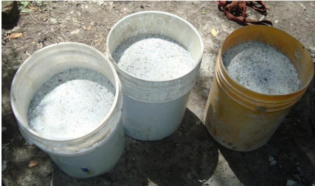
Imagen 3.9.3. Detalle de dosificación del agregado.
