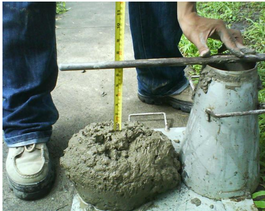
Imagen 3.10.2. Prueba de revenimiento para la mezcla de a/c de 0.6 usando agregado pétreo.
