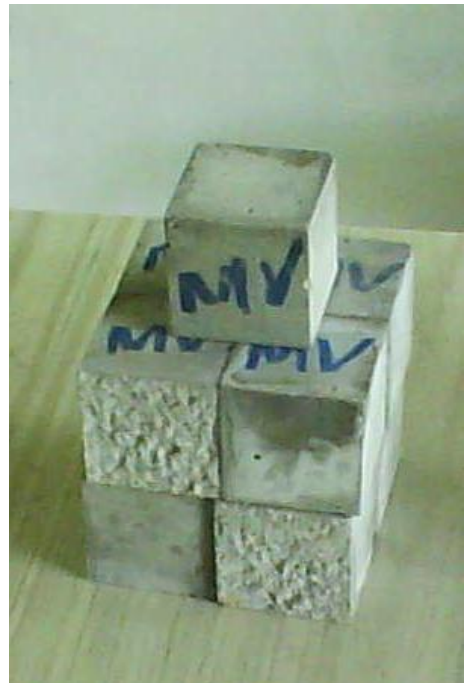
Imagen 4.3.4. Elementos de Mortero Tipo "S" con agregado Vítreo.
