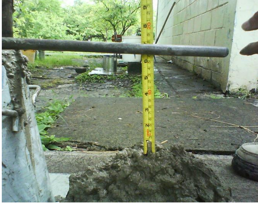
Imagen 3.10.1. Prueba de revenimiento para la mezcla de a/c de 0.5 usando agregado pétreo.
