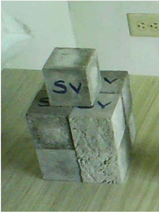
Imagen 4.3.1. Elementos de Mortero Tipo "S" con agregado Vítreo.
