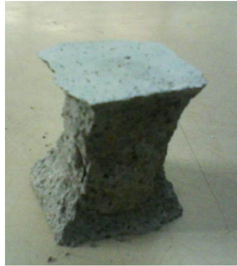
Imagen 4.3.6. Tipos de falla en algunos especímenes de Mortero.
