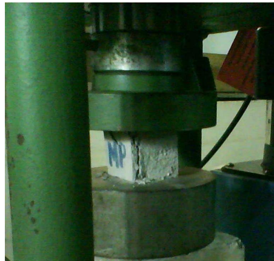
Imagen 4.3.8. Momento en el que el cubo está siendo sometido a compresión.
