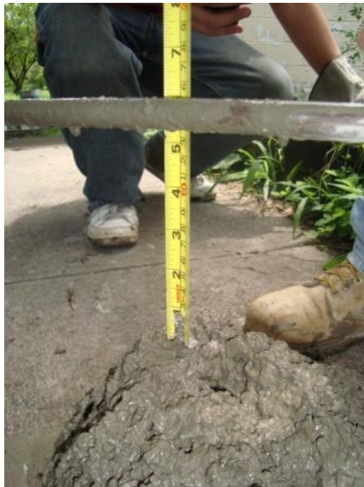
Imagen 3.10.5. Prueba de revenimiento para la mezcla de a/c de 0.5 usando agregado vítreo.
