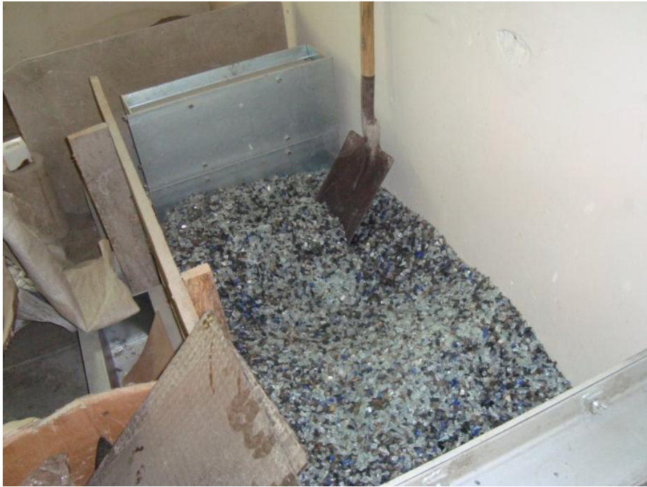
Imagen 3.9.1. Detalle de Vidrio reciclado luego de ser reducido.
