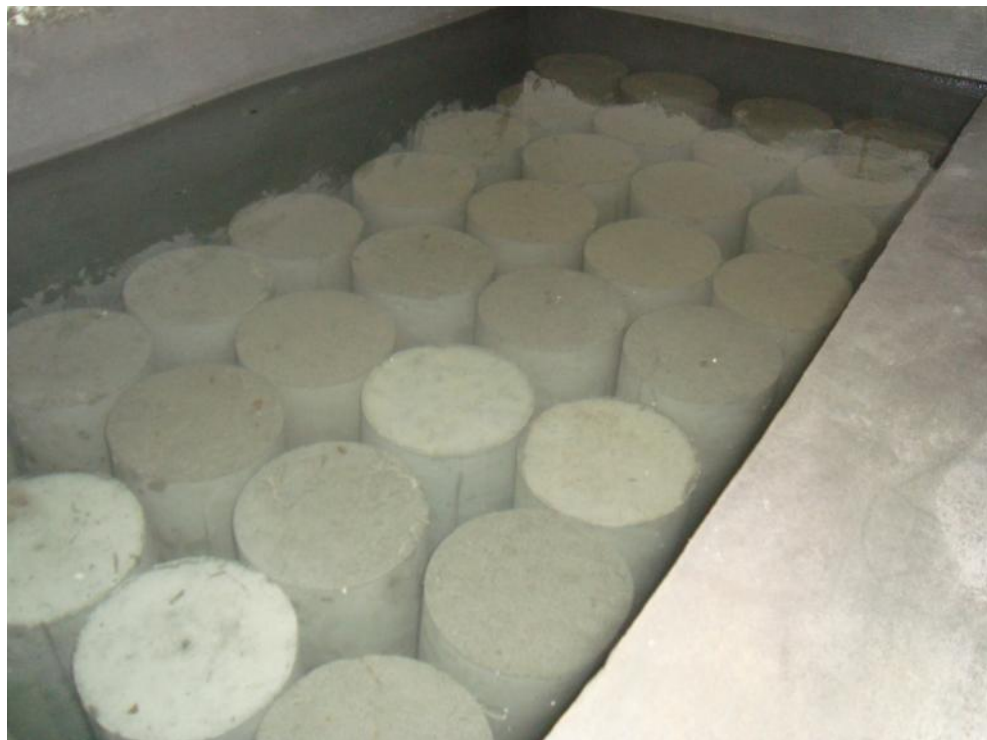
Imagen 3.9.8 Curado de los Cilindros.
