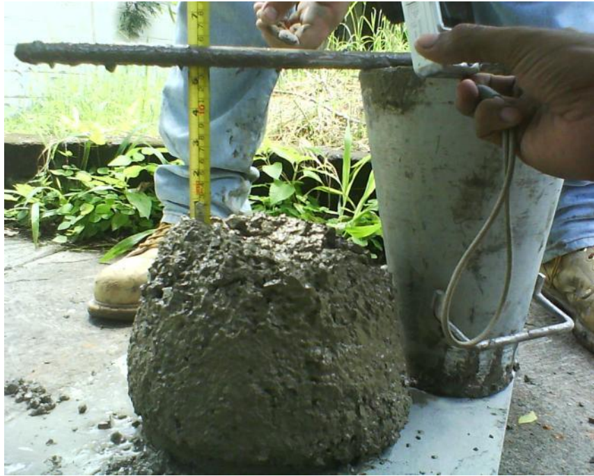
Imagen 3.10.7. Prueba de revenimiento para la mezcla de a/c de 0.6 usando agregado vítreo.
