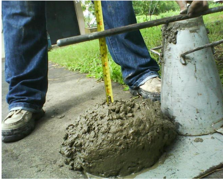
Imagen 3.10.3. Prueba de revenimiento para la mezcla de a/c de 0.65 usando agregado pétreo.
