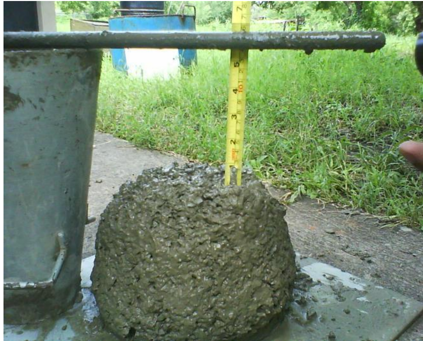
Imagen 3.10.8. Prueba de revenimiento para la mezcla de a/c de 0.6 usando agregado vítreo.
