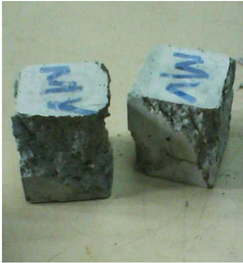
Imagen 4.3.5. Elementos de Mortero Sometidos a Compresión.
