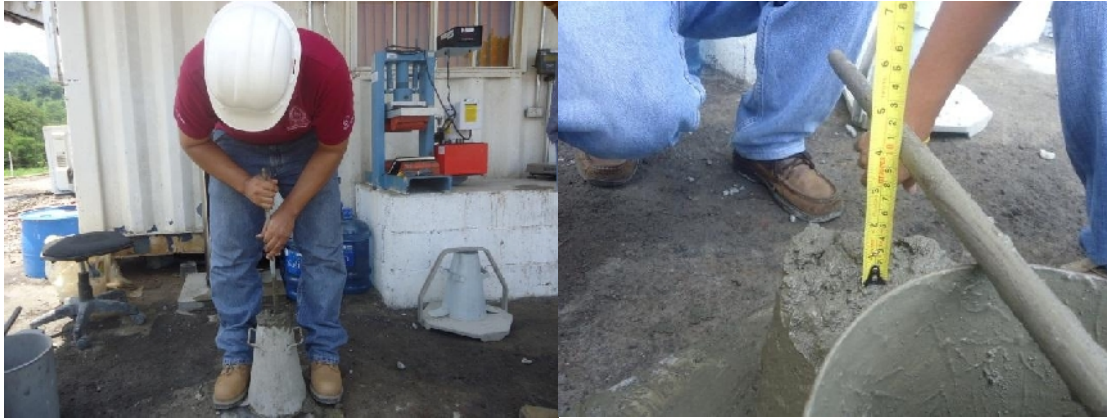
Figura 3.8 Resumen Fotográfico. Revenimiento del concreto en estado fresco.
