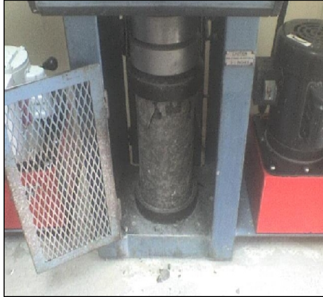
FIGURA 2.2: Inicio de la falla del cilindro expuesto a esfuerzos de compresión axial.
