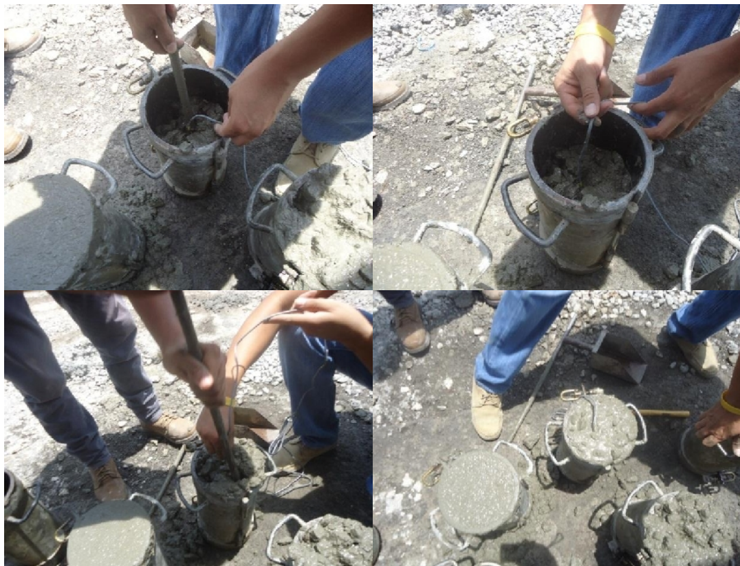
Figura 3.10 Resumen Fotográfico. Introducción de sensores en el centro del cilindro, cuando se colocaba la 2da capa.
