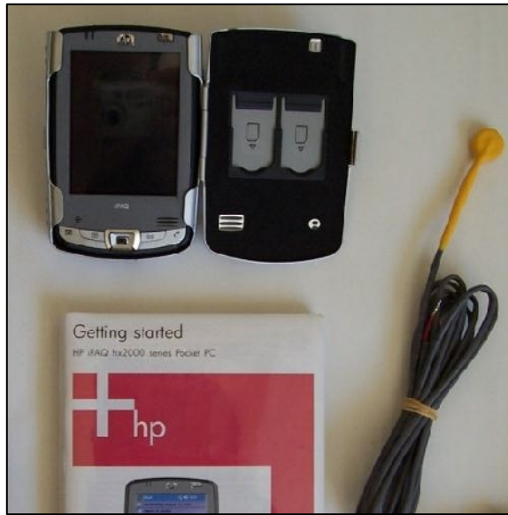
Figura 3.14 -Equipo de madurez: Pocket PC, Software COMMAND CERTER, sensor Térmico o termocupla.
