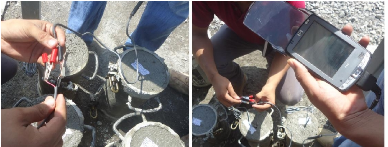
Figura 3.20: conectando el sensor al Pocket Pc y leyendo los datos de temperatura y madurez con el software COMMAND CENTER.
