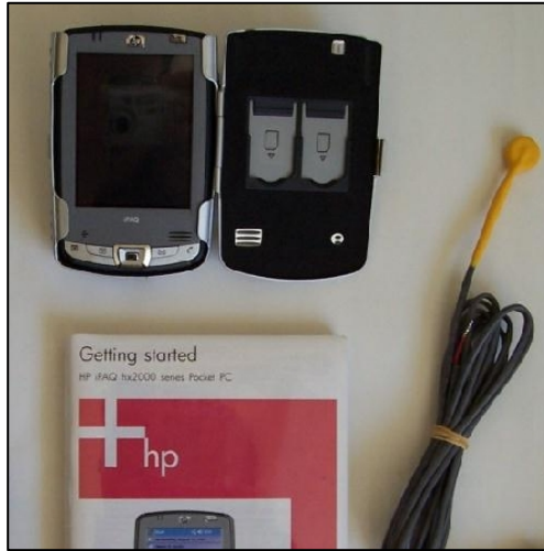
Figura-2 Equipo de madurez: Pocket PC, Software COMMAND CERTER, sensor Térmico o termocupla.
