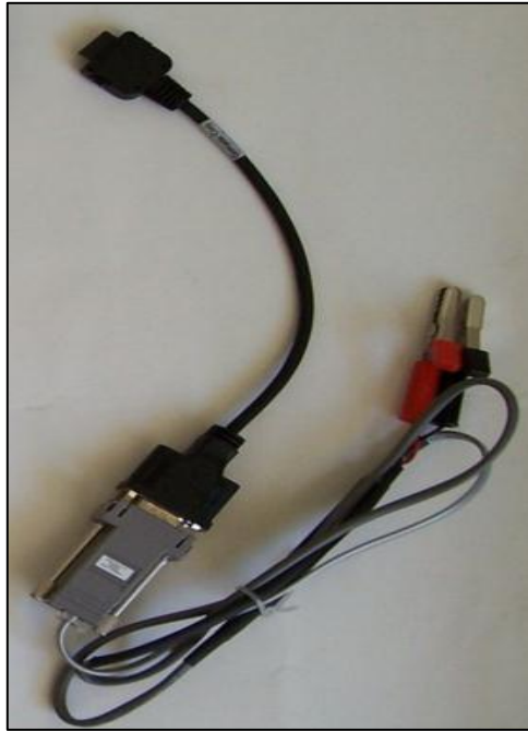
Figura 3.19: Cable serie 9-pin que conecta los sensores a la Pocket PC para la lectura de datos.
