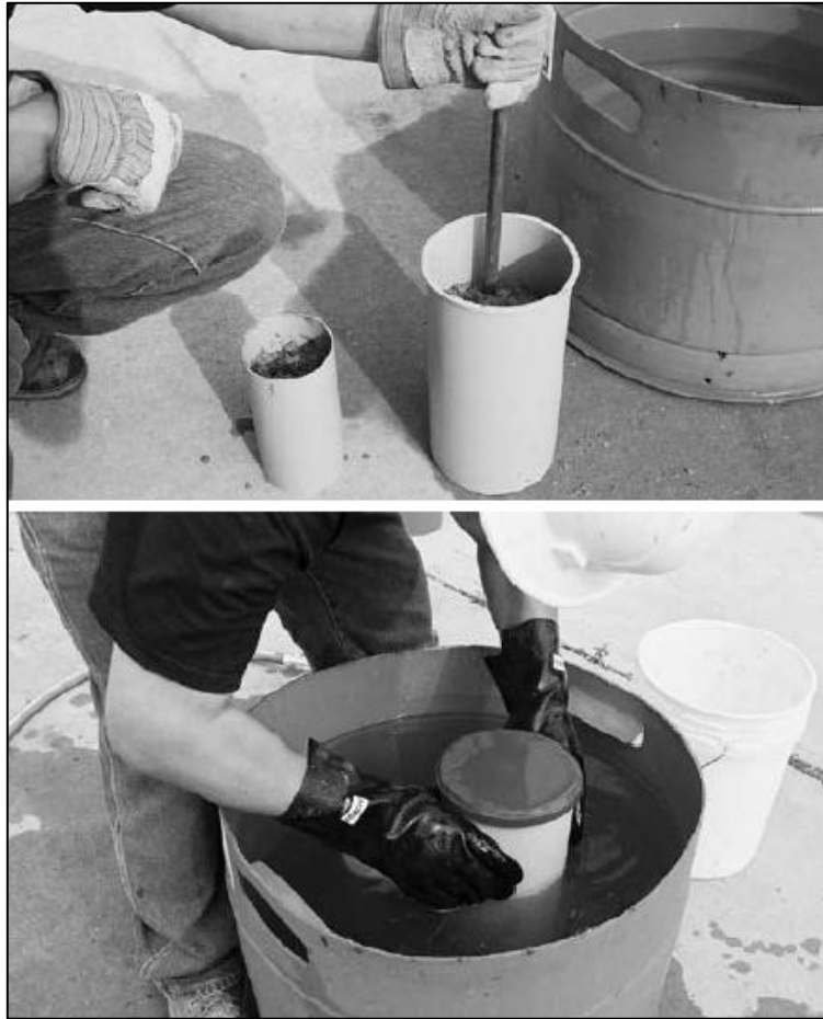
Figura 2.1: preparación y curado de cilindros de concreto en campo
