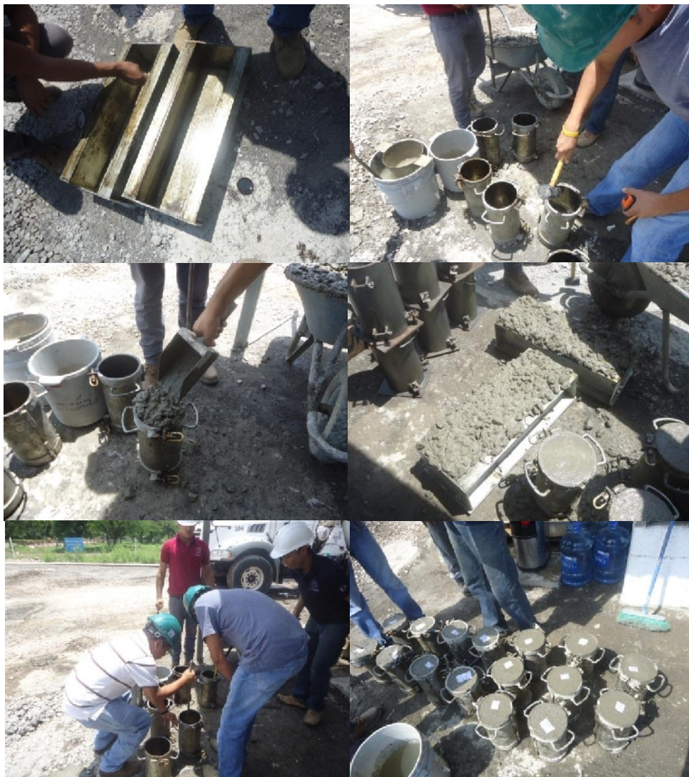
Figura 3.9 Resumen Fotográfico. Aplicación de desmoldante, llenado de probetas cilíndricas y vigas y rotulación final.
