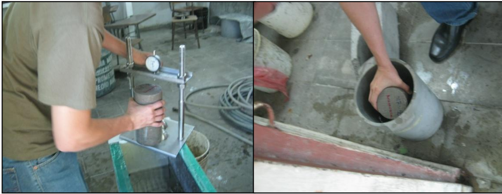
Fig. 3.42: Desmontando el espécimen y conservándolo en agua fría.
