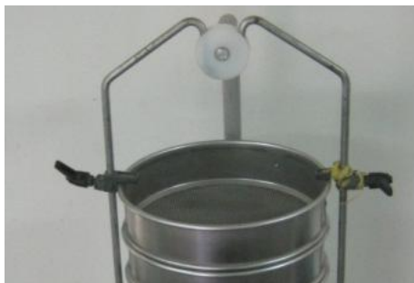
Fig. A-5 Tamices certificados de abertura cuadrada, usados para el ensayo granulométrico
