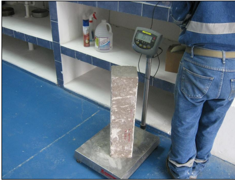
Fig. 3.48: Pesando el espécimen.
