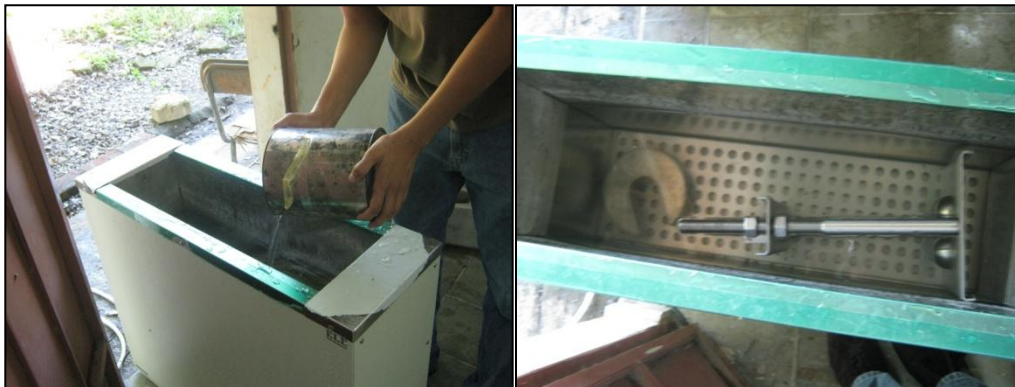
Fig. 3.43: Llenando el baño de agua junto con el montaje con agua caliente.
