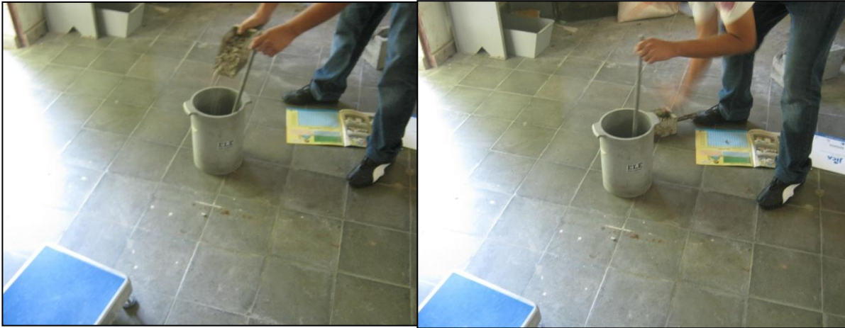
Fig. 3.20: Colocando y apisonando en tres capas el agregado
