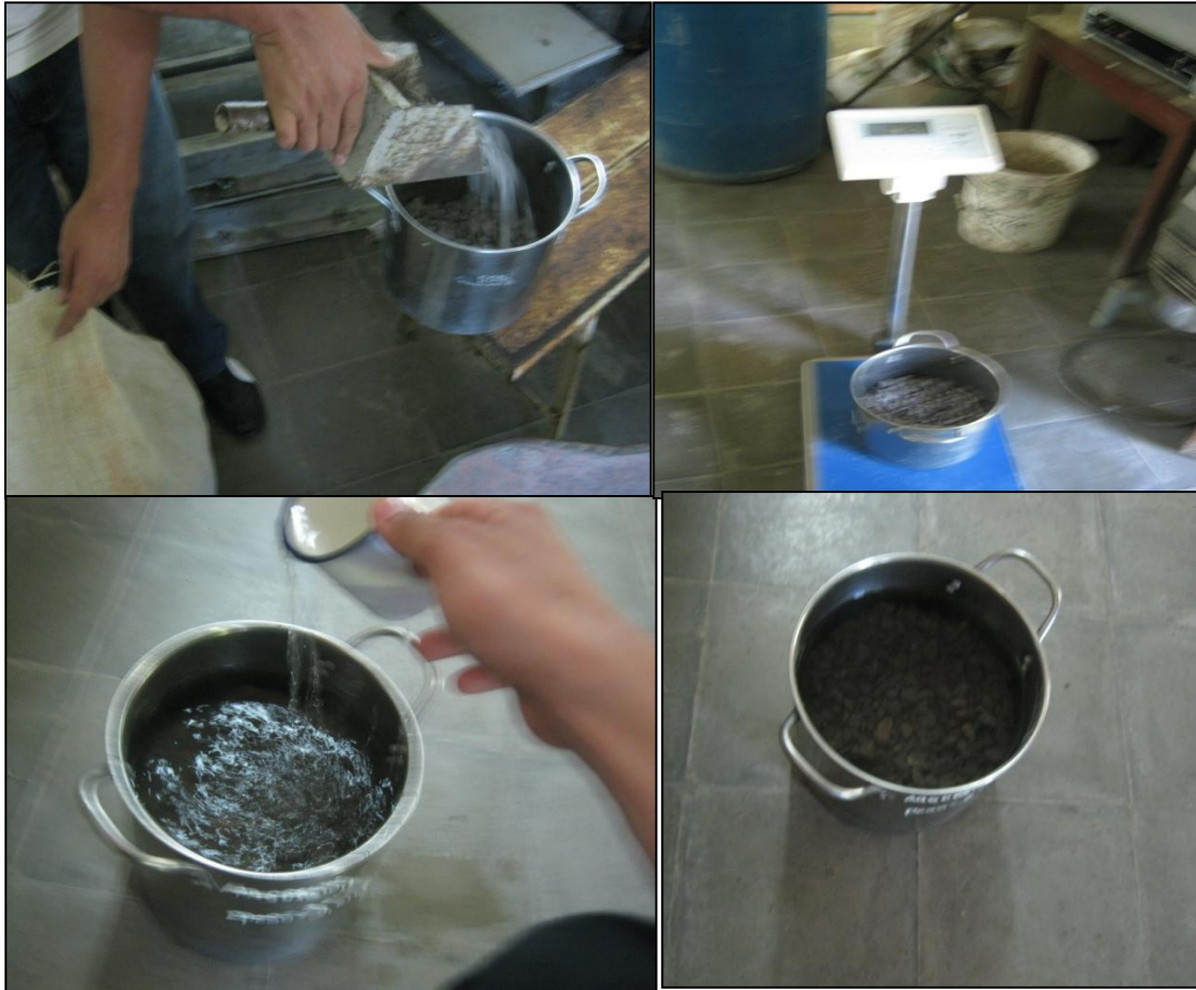
Fig. 3.23: Tomando la muestra, pesándola y sumergiéndola en agua por 24 horas.
