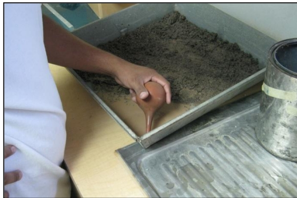
Fig. 3.30: Retirando el agua acumulado después de la sedimentación del agregado.
