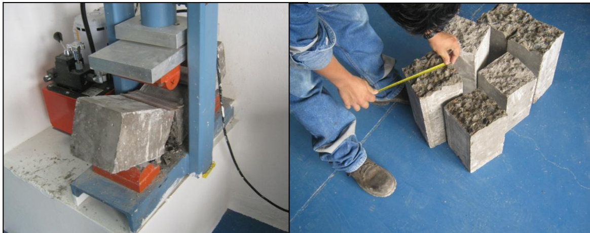
Fig. 3.51: Leyendo la carga de ruptura y las dimensiones en la falla del espécimen.
