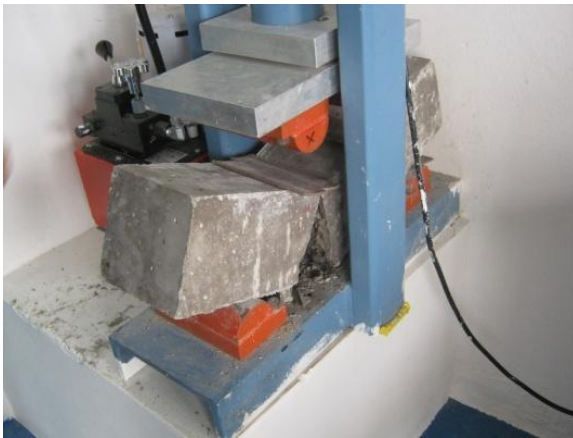
8) FALLA DE UNA VIGA
