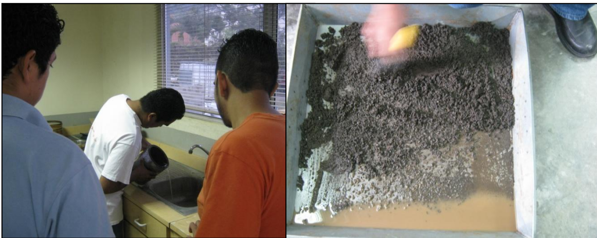
Fig. 3.29: Removiéndole el agua y exponiendo el agregado al aire para su secado superficial.
