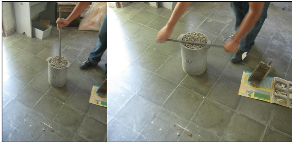
Fig. 3.21: Apisonando y enrasando la ultima capa
