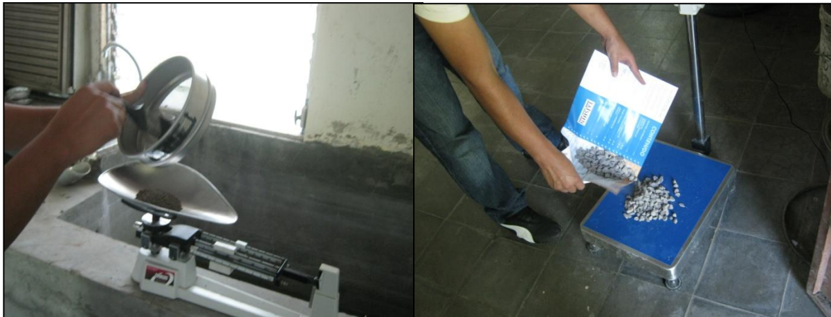
Fig. 3.9: Pesando los porcentajes retenidos de la muestra de agregado en cada malla.
