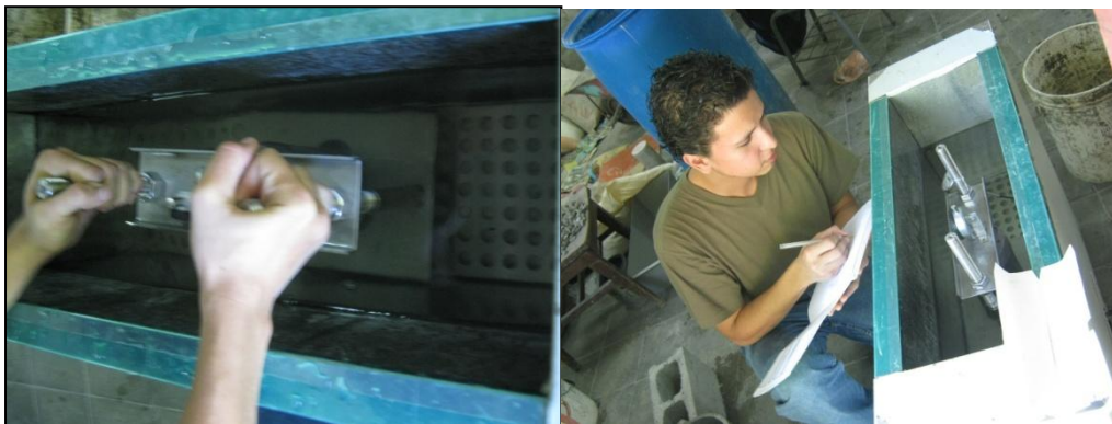
Fig. 3.44: Sumergiendo el espécimen en agua caliente y leyendo sus deformaciones.
