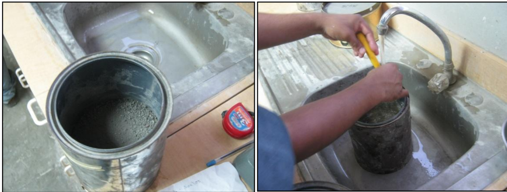
Fig. 3.28: Tomando una muestra de agregado fino y saturándola en agua por 24 horas.
