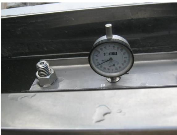
9) EJEMPLO DE MOMENTO EN QUE SE TOMA LA LECTURA DE DEFORMACION
