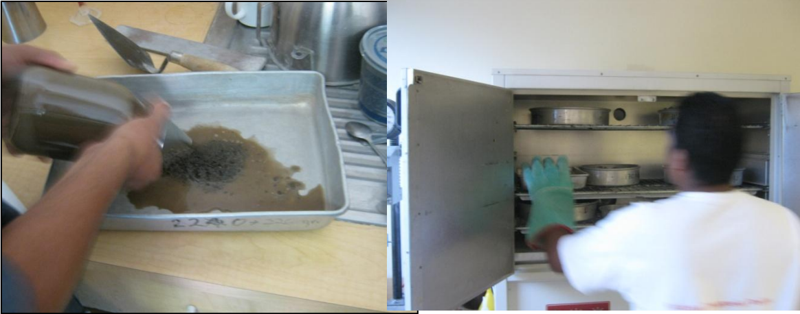
Fig. 3.37: Vertiendo la muestra y su contenido en un recipiente y sometiéndola a secado al horno.
