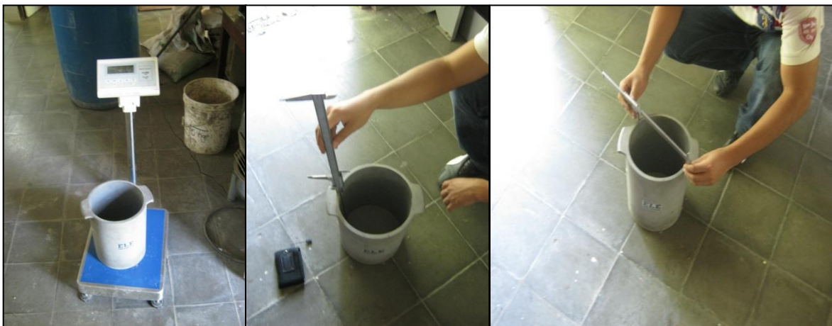
Fig. 3.19: Pesando y midiendo las dimensiones internas del recipiente pertinente
