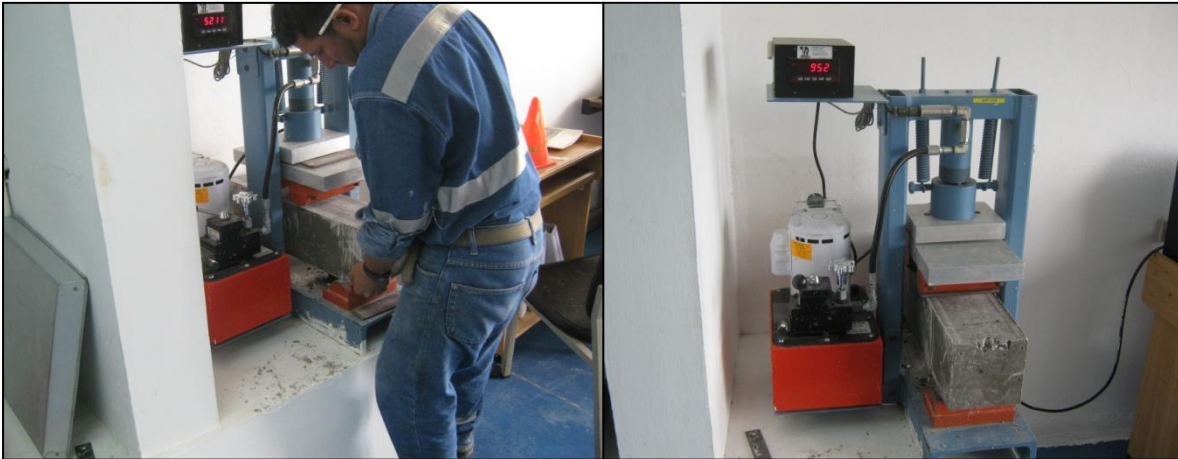
Fig. 3.50: Colocando la muestra en la prensa hidráulica y sometiéndola a flexión.
