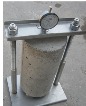
7) COLOCACION DEL ESPECIMEN EN EL MARCO.
