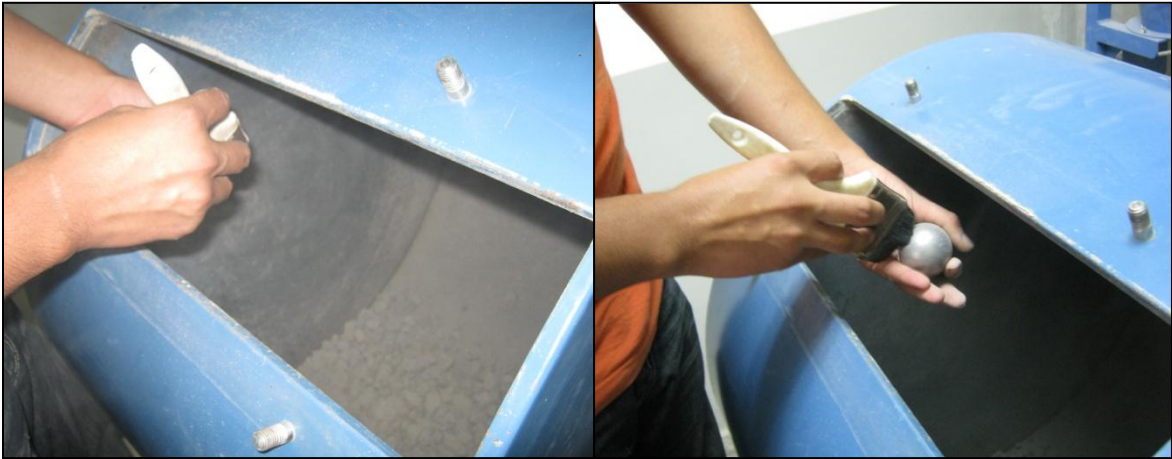
Fig. 3.12: Suministrando en la máquina de los ángeles la muestra y las esferas seleccionadas.
