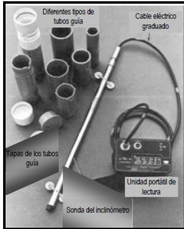
Figura 5.10 Vista de un inclinómetro y de su equipo de medición en la superficie.
