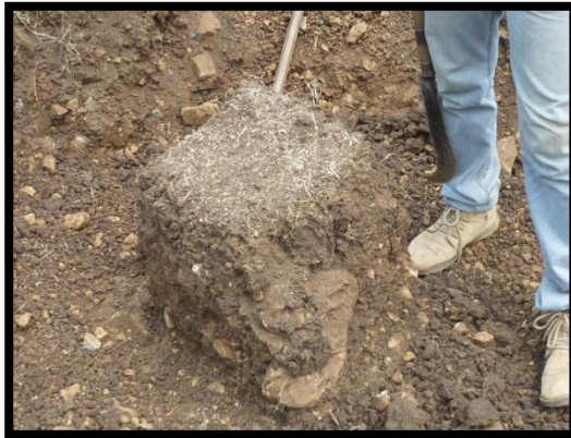
Figura 4.27 Presencia de Cantos en el interior del terreno y desmoronamiento de muestra.
