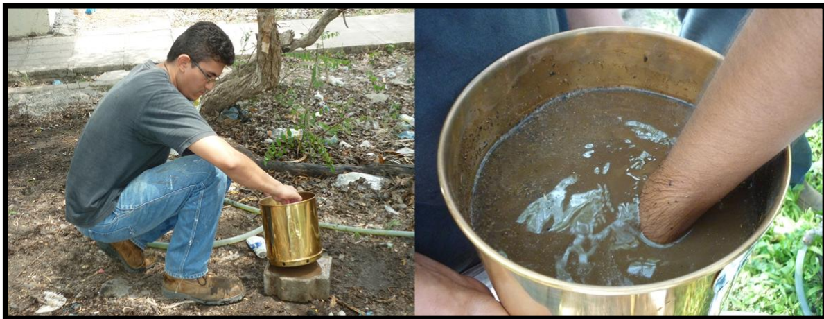
Figura 4.58 Lavado de material fino con malla N°200.
