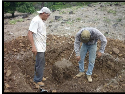
Figura 4.27 Presencia de Cantos en el interior del terreno y desmoronamiento de muestra.
