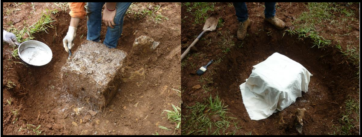
Figura 4.62 Protección de muestras con parafina y manta antes de su empaquetamiento.
