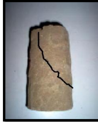
Figura 3.15 Superficie de falla ocurrida al espécimen
