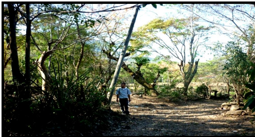
Figura 4.12 Inclinación del poste que revela el movimiento de laderas.
