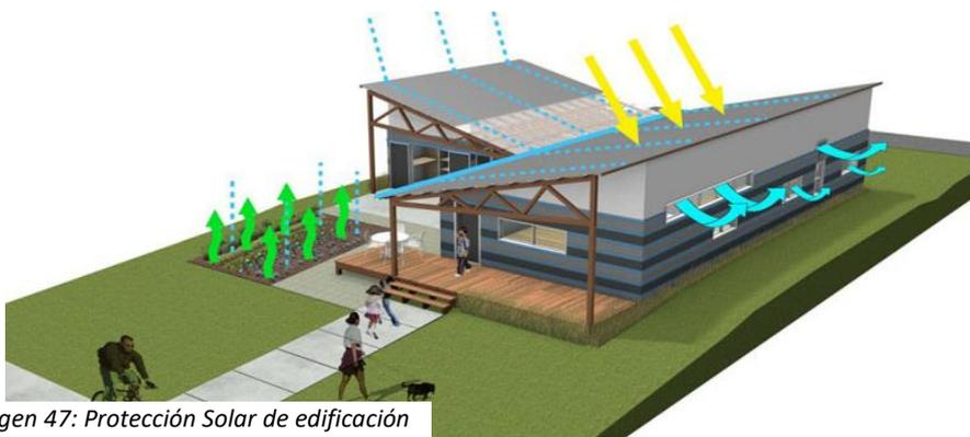
Imagen 47: Protección Solar de edificación
