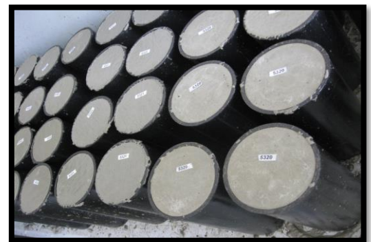
Figura 37. Cilindros de pruebas de compresión, fuente: www.ingenieriareal.com
