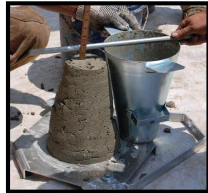
Figura 32. Prueba de revenimiento, fuente: www. Ingenieríareal.com
