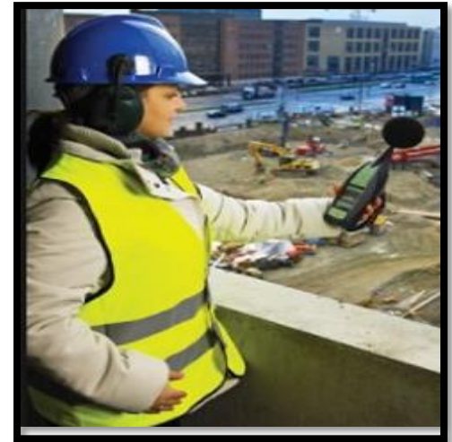
Figura 50. Monitoreo con sonómetro en la obra, fuente: Google imágenes
