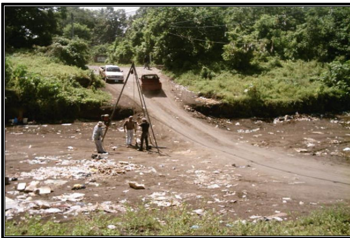
Fig. 3.7 Imagen que muestra la cuadrilla de perforadores realizando uno de los sondeos de la prueba de penetración estándar (SPT) en el punto de emplazamiento.
