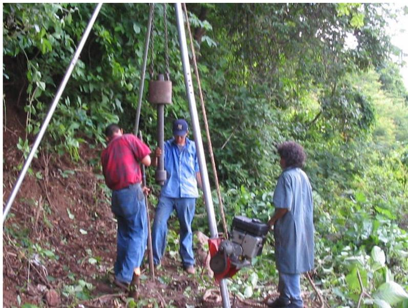
**Fotografía 3.6.** En esta fotografía se muestra la realización de los sondeos hechos en el sitio de emplazamiento del puente.
