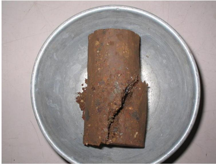
**Fotografía 3.3.** Fotografía que muestra el tipo de falla en una de las probetas ensayadas en el laboratorio.
