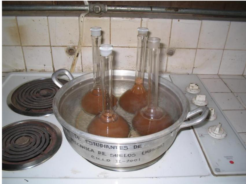
**Fotografía 3.4.** Procedimiento de desairado del suelo para encontrar la gravedad específica del mismo.
