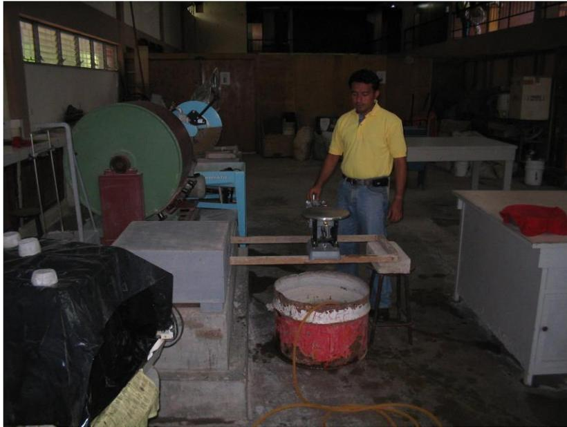
**Fotografía 3.5.** En esta fotografía se muestra el procedimiento para la realización del ensayo para determinar la gravedad específica del agregado grueso.
