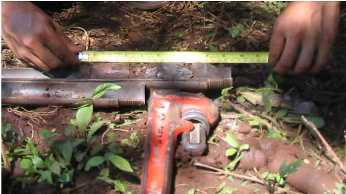
**Fotografía 3.7.** Obtención de muestras de la cuchara partida para conocer la estratigrafía del suelo de cada sondeo.
