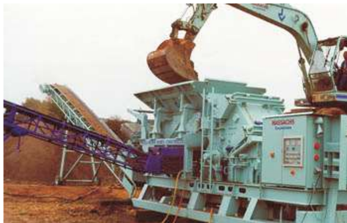
Figura 3.10 Maquinaria móvil para el reciclaje de escombros. C. Meléndez
