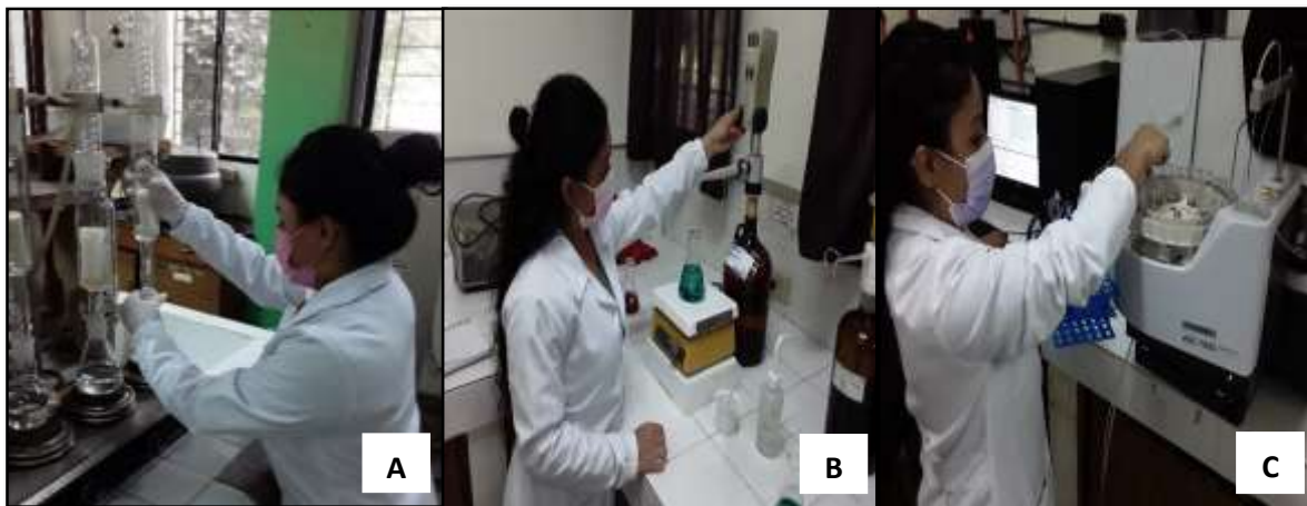
Figura 2. Análisis de laboratorio. (A) Determinación de extracto etéreo (B) Determinación de Nitrógeno proteico (C) Determinación de minerales
