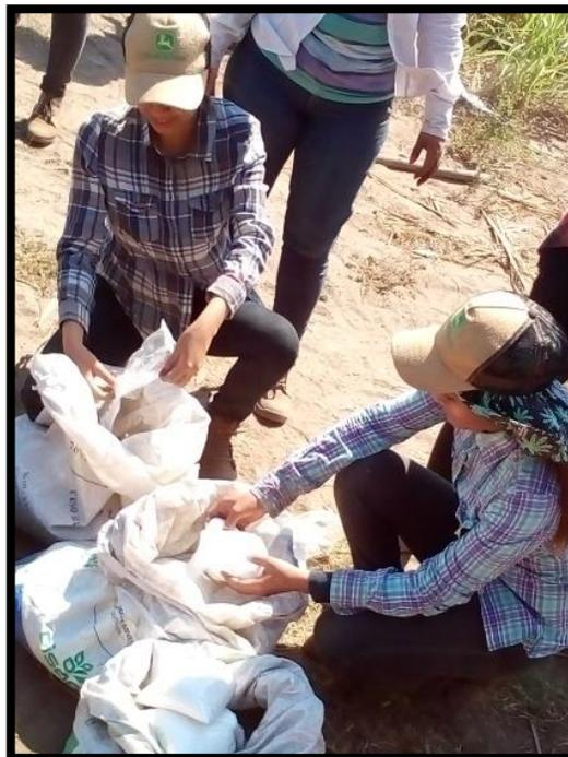
Figura A- 5. Mezclado de polímero solido con suelo seco.
