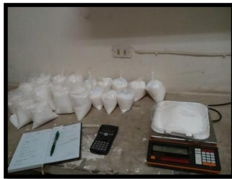
Figura A-3. Pesaje de las diferentes dosis a evaluar.
