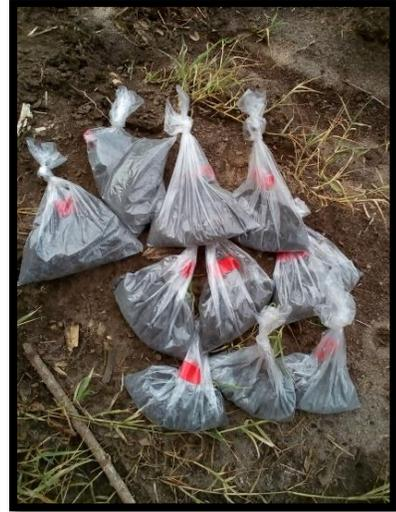
Figuras A-10 y A-11. Extracción de muestra de suelo para análisis de humedad.
