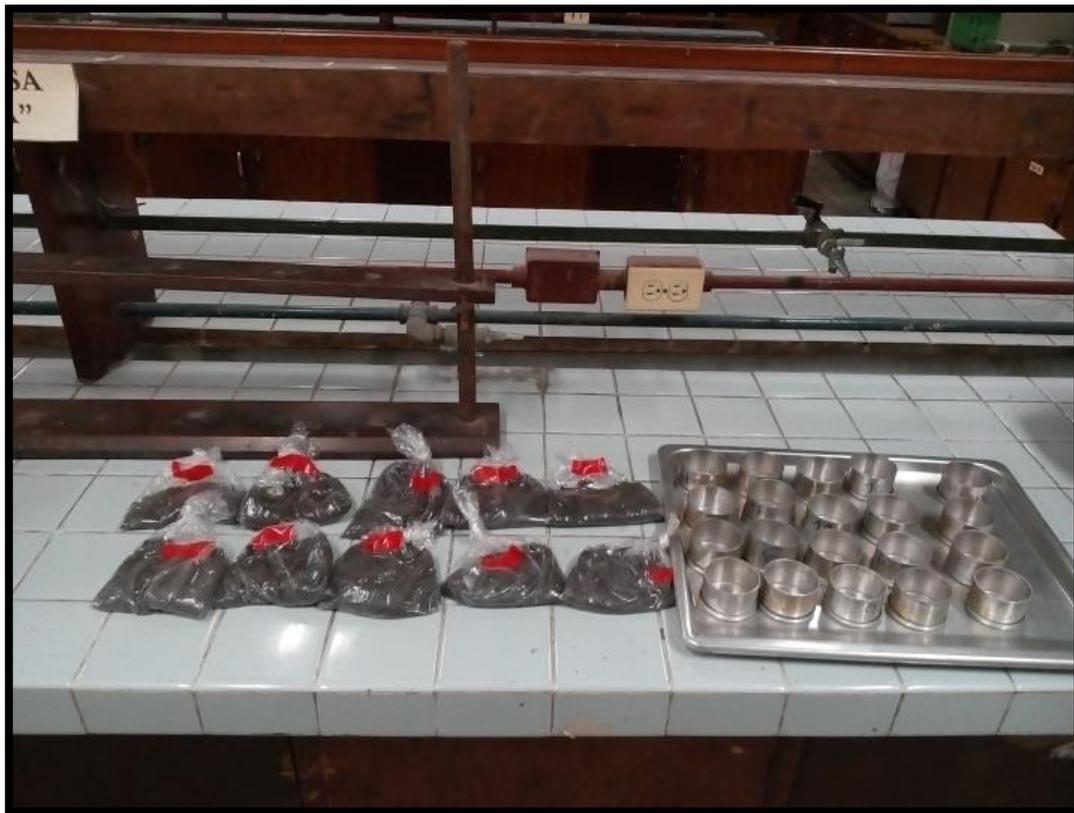
Figura A-12. Análisis de humedad gravimétrica a muestras de suelo.
