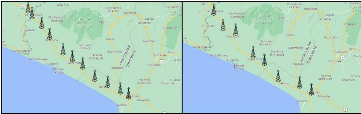
Figura 30: Comparativa de cantidad de estaciones base para una red operando en la banda de 1900 MHz y en 850 MHz. (H. Torres, 2022)
