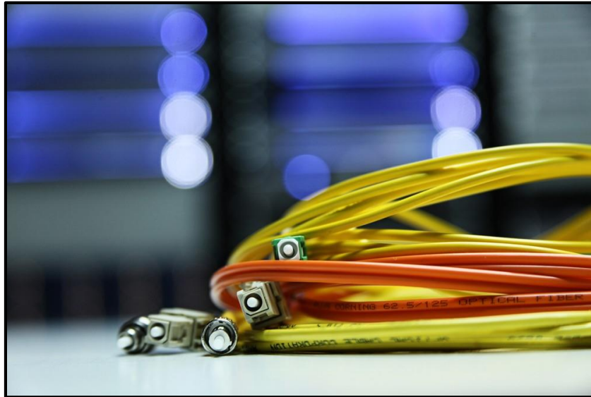
Figura 36: Hilos de fibra óptica utilizados para la interconexión de eNodeBs. (Imagen libre, 2022).
