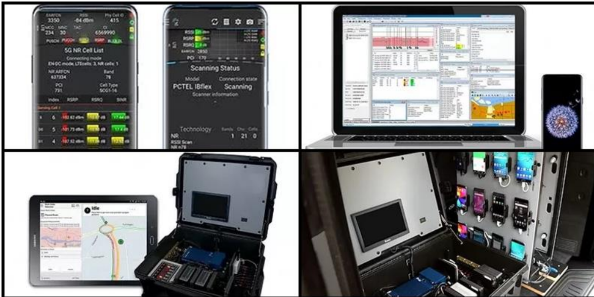
Figura 45: Equipos para realización de Drive Test. TEMs Investigation. (H. Torres, 2022)
