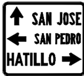
Figura 44: Señal vertical informativa de destino.
