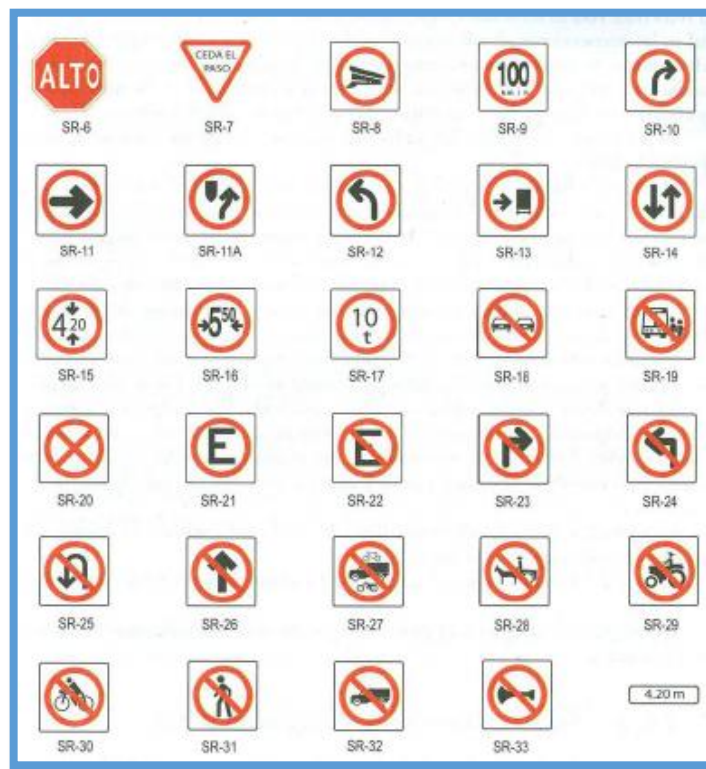
Figura 3: Señales restrictivas de tránsito.
