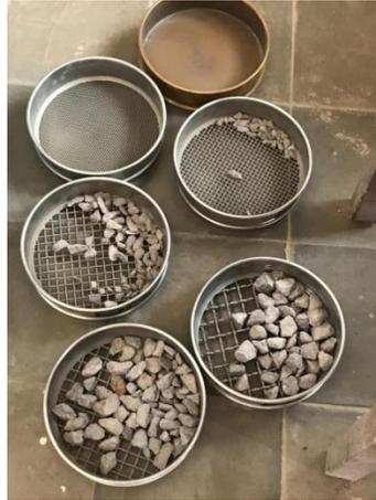
**Figura 4-18 Material retenido en mallas.**
