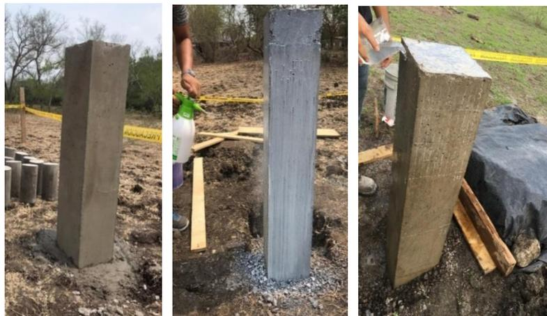
**Figura 4-38 Columna aplicados los tratamientos de sin curar, membrana plástica y riego periódico.**
