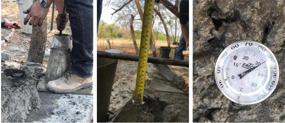
**Figura 4-30 Revenimiento y medición de temperatura.**
