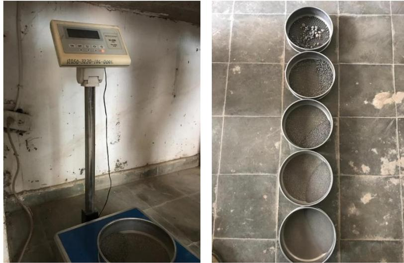
**Figura 4-9 Material retenido en tamices**
