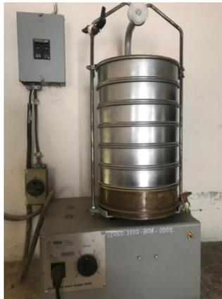
**Figura 4-8 Agregado fino en agitador mecánico.**
