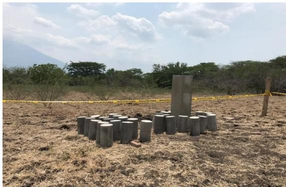
**Figura 4-33 Cilindros sin curar expuestos al ambiente**
