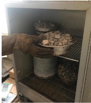
**Figura 4-20 Colocación de material en horno.**
