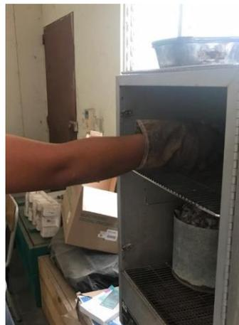
**Figura 4-21 Extracción de agregado del horno**
