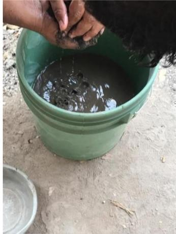
**Figura 4-10 Extracción de agregado fino saturado**
