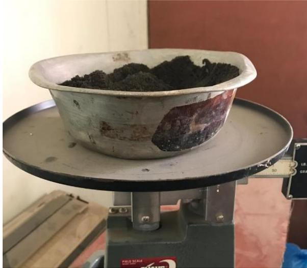
**Figura 4-12** Peso muestra en condiciones SSS.
