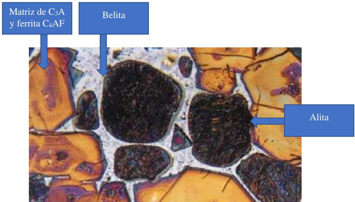
**Figura 2-3 Microestructura de materiales base del cemento.**
