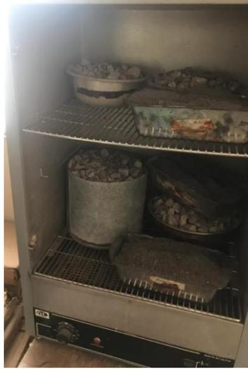
**Figura 4-5 Agregado fino en secado**
