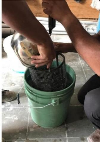
**Figura 4-27 Pesado de material sumergido.**
