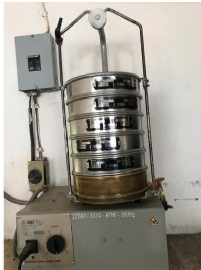
**Figura 4-17 Mallas en agitador.**
