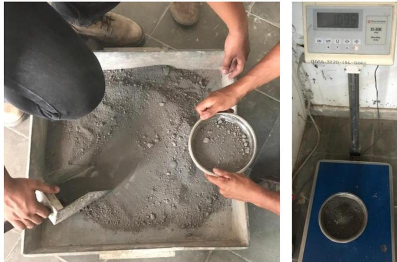
**Figura 4-6 Peso de muestra para granulometría de agregado fino**
