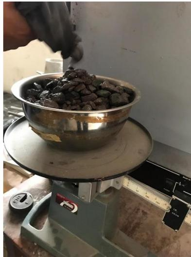
**Figura 4-26 Agregado pesado en condiciones SSS.**
