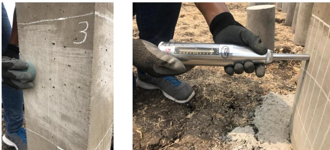
**Figura 4-41 Ensayo de esclerometría.**
