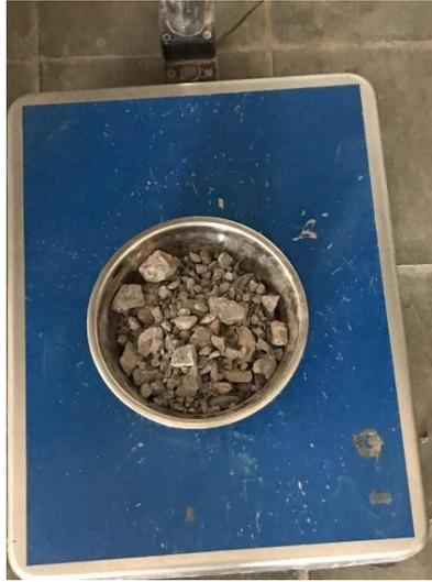
**Figura 4-15 Pesado de agregado grueso**
