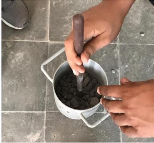
**Figura 4-22 Varillado de agregado grueso.**
