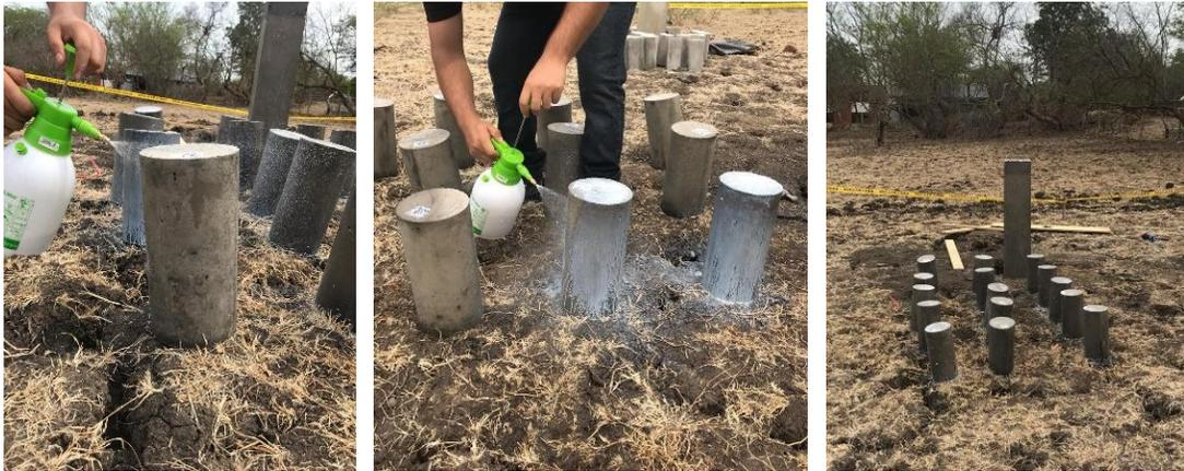
**Figura 4-34 Aplicación de membrana plástica y exposición al ambiente.**
