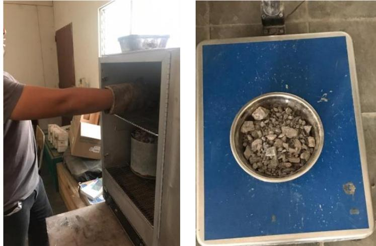
**Figura 4-24 Pesado de material seco.**
