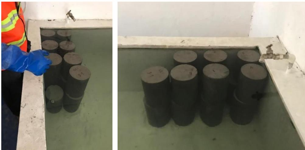
**Figura 4-36 Cilindros curados en pilas con temperatura controlada**
