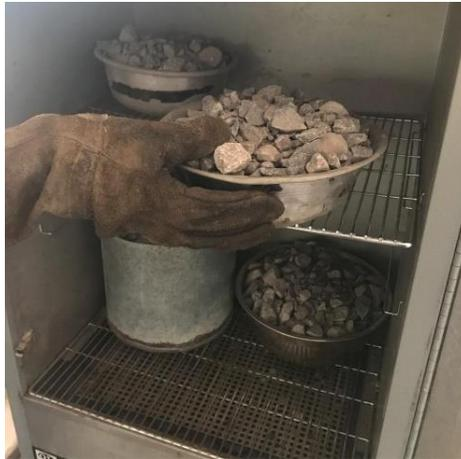
**Figura 4-14 Agregado grueso en horno.**
