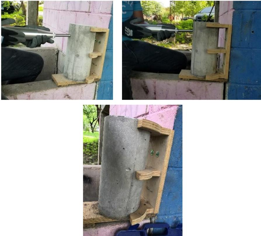
**Figura 4-42 Ensayo de esclerometría en cilindros.**
