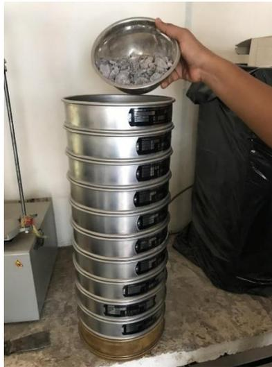
**Figura 4-16 Agregado grueso en tamices.**
