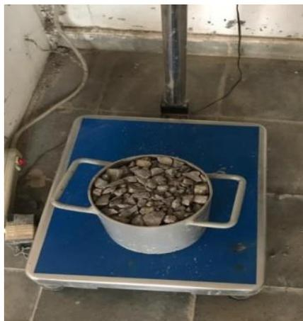
**Figura 4-23 Peso de recipiente con agregado grueso.**
