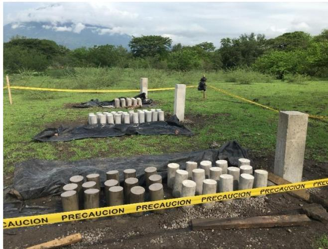
**Figura 4-32 Cilindros expuestos a las condiciones ambientales de campo.**
