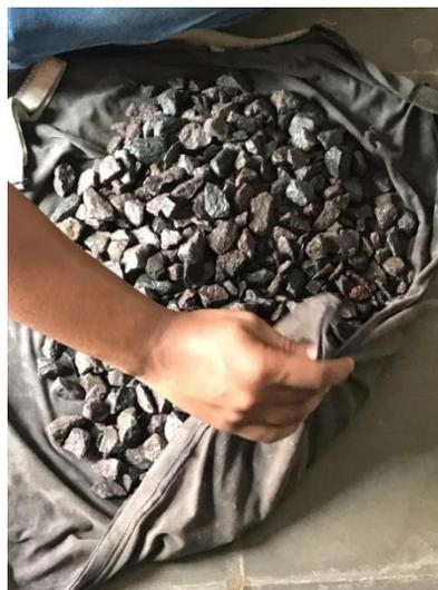
**Figura 4-25 Agregado en condición SSS**
