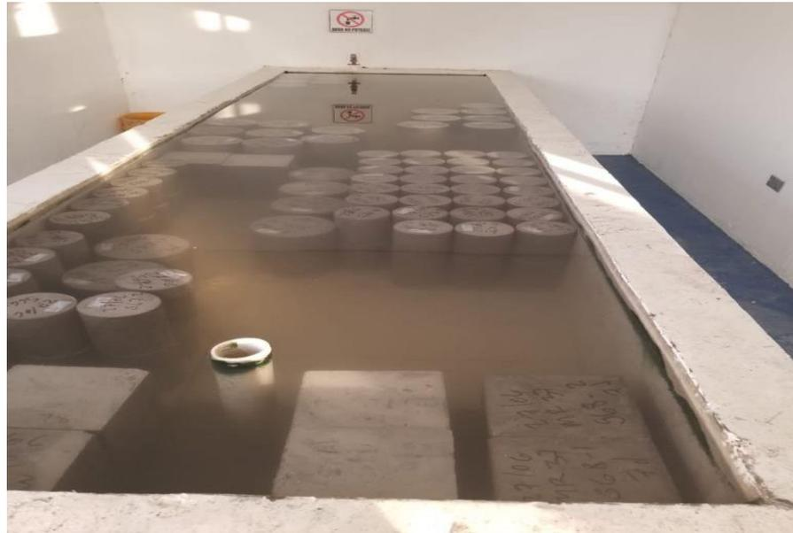
**Figura 2-14 Método de curado por inmersión en pilas**
