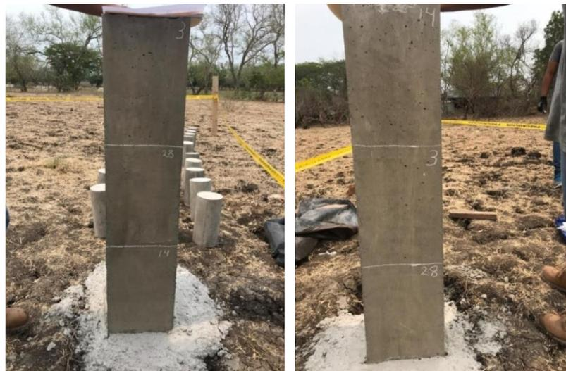
**Figura 4-39** Cara 2 y cara 4 de columna con áreas asignadas aleatoriamente.
