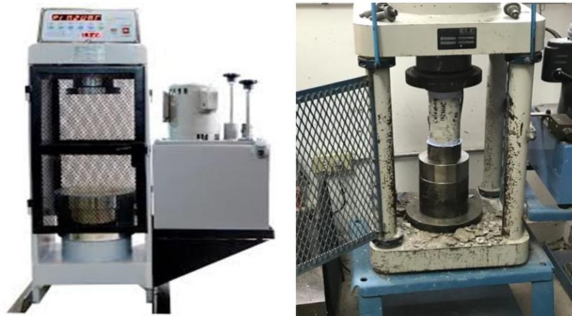
**Figura 2-22 Aspecto que posee una máquina de ensayo a compresión.**
