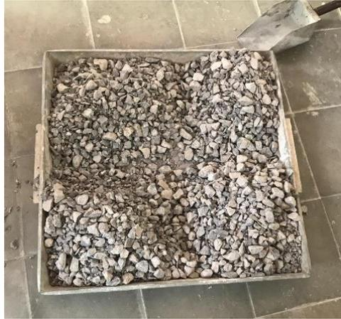
**Figura 4-13 Cuarteo manual de agregado grueso.**
