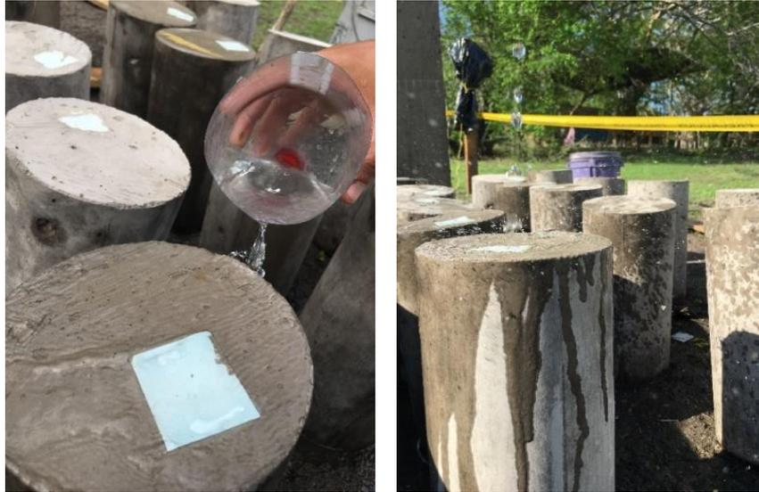
**Figura 4-35 Cilindros curado por riego periódico.**
