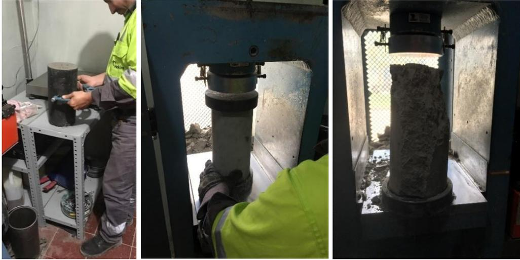
**Figura 4-43** Ensayo a compresión de cilindros.
