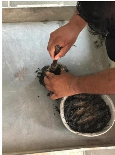
**Figura 4-11 Agregado fino en condición SSS**
