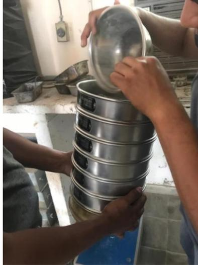
**Figura 4-7 Colocación de muestra en tamices**
