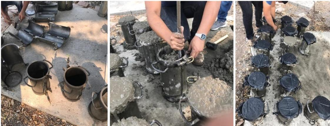
**Figura 4-31 Aceitado de moldes y elaboración de cilindros**
