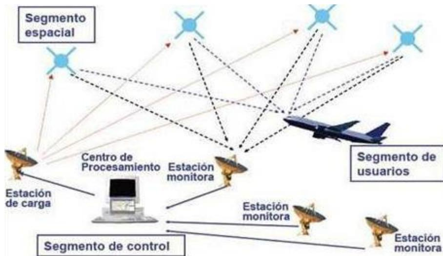
Figura 15 Esquema de ejemplo de cómo se comunica un sistema satelital con las estaciones en tierra. (Sistemas de navegación satelital y su aplicación en Guatemala, s.f)
