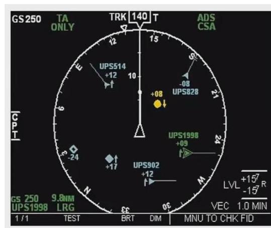
Figura 7 Visualización de pantalla de información de tráfico abordo (CDTI). (ADS-B y Terminal de exhibición del radar 7.3 CDTI ADS-B, s.f.).
