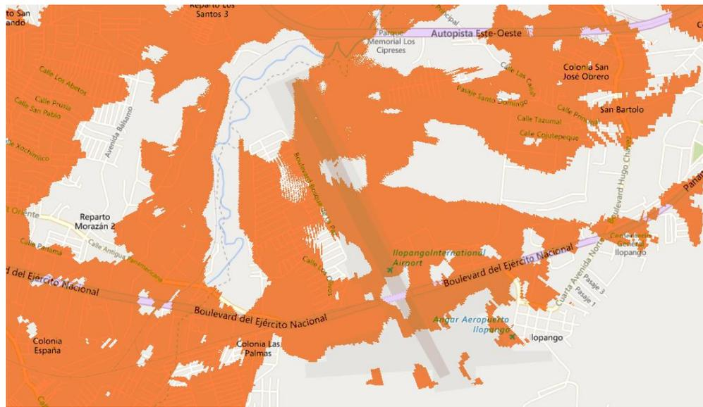
Figura 30 Cobertura visual que obtenemos con la antena 5 MLAT hacia un punto cualquiera a 1.5 metros de altura sobre la pista y hangares.
