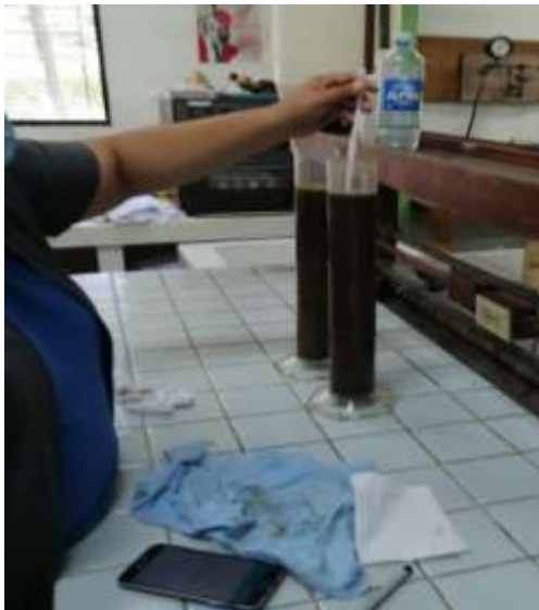
Figura 21. Toma de temperatura y hidrómetro
