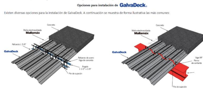
Imagen 7. Vista de lámina de losa galvadeck. Fuente: metalco.net/productos/tubería-estructural .
