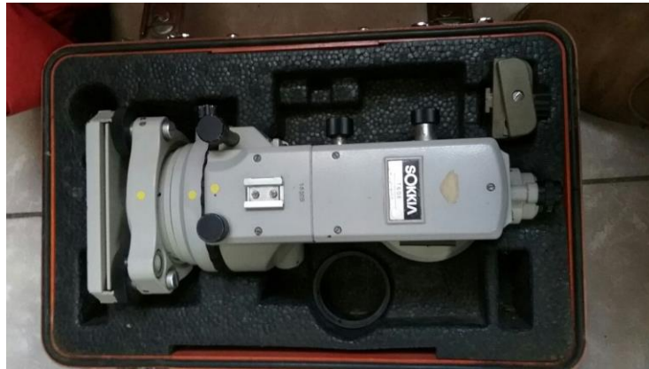
ILUSTRACIÓN 7. TEODOLITO SOKKIA T60, ACTUALMENTE EN MAL ESTADO.
