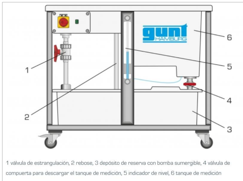
Ilustración 2. Descripción del equipo: Modulo básico para ensayos sobre mecánica de fluidos.
