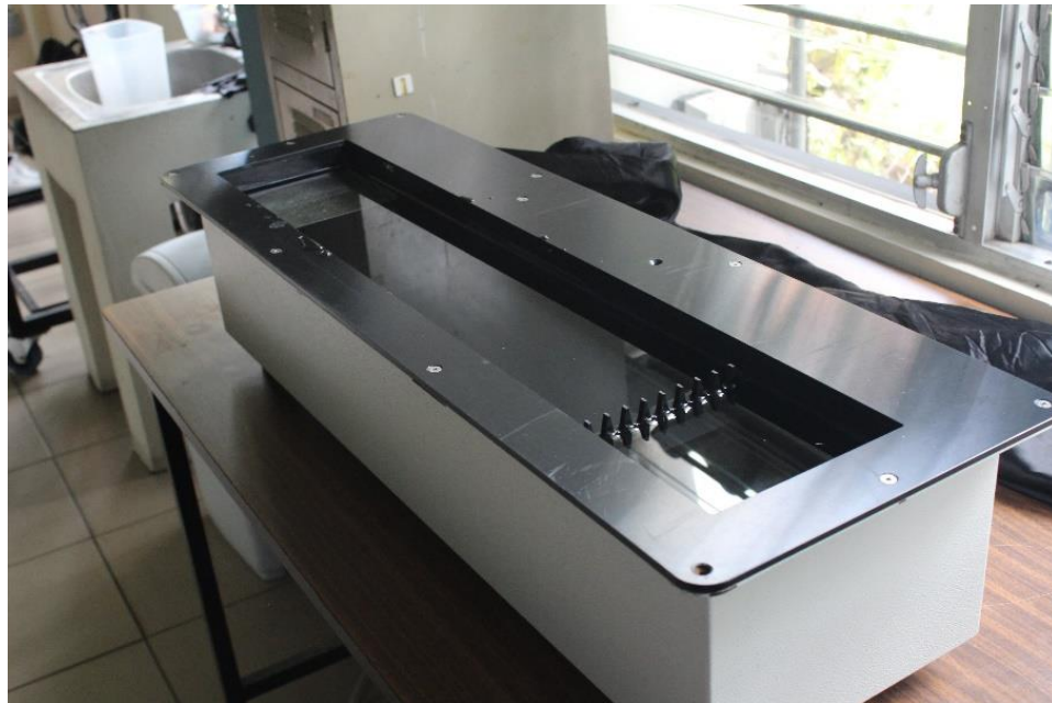
ILUSTRACIÓN 11. EQUIPOS DE VISUALIZACIÓN DE FLUJOS DEL LABORATORIO DE CIENCIAS ENERGÉTICAS Y FLUIDICAS- UCA.
