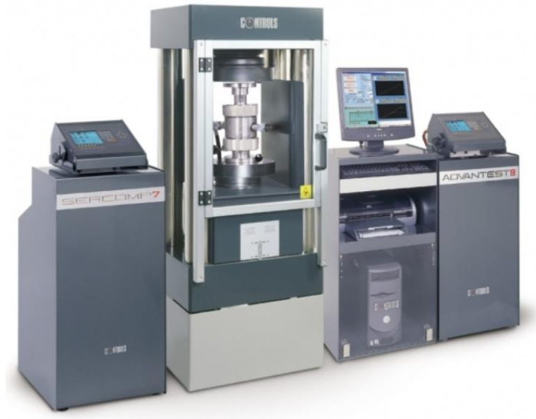
Ilustración 48. Sistema automático uniaxial y triaxial.
