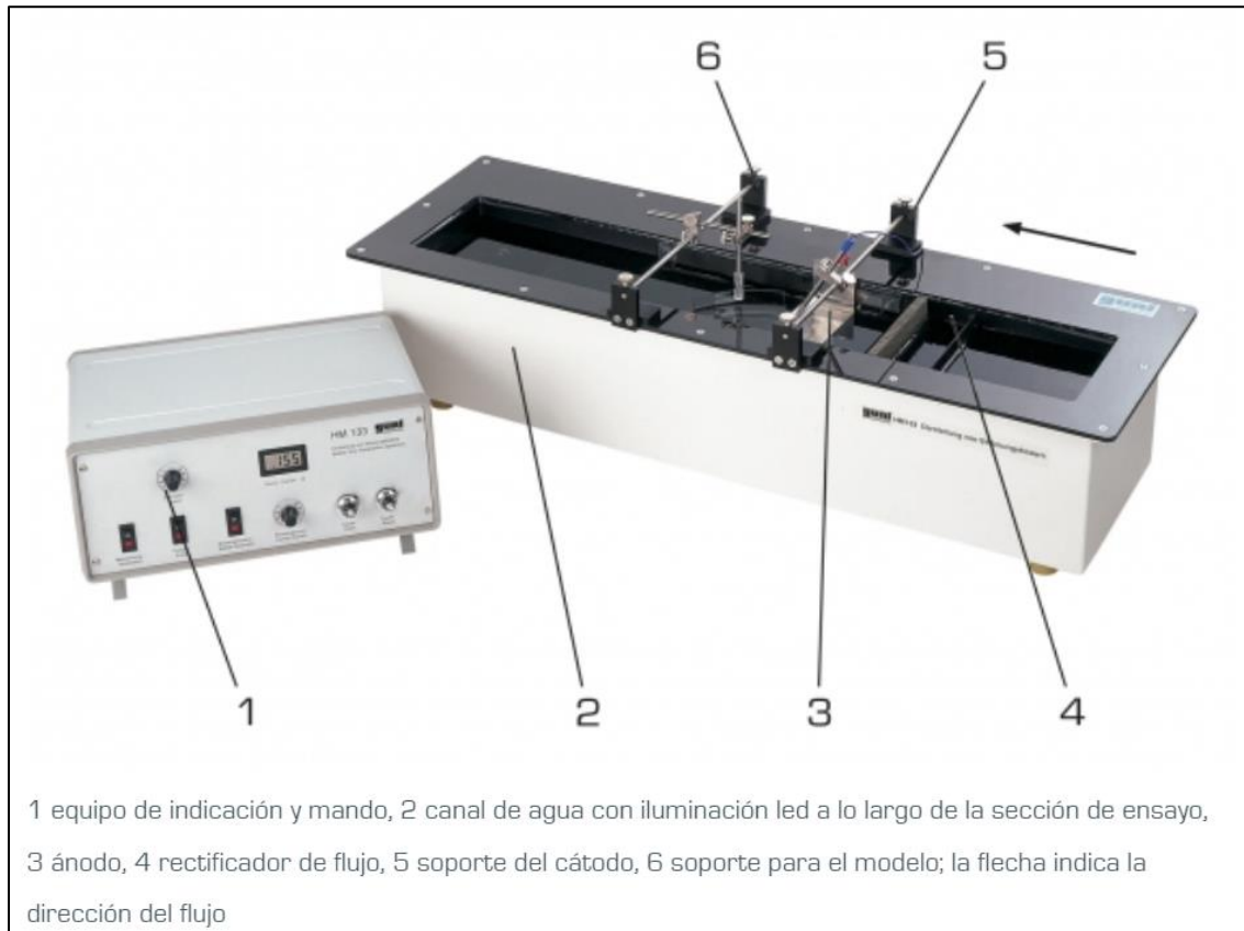
Ilustración 27. Descripción del equipo: Cinemática de los fluidos.
