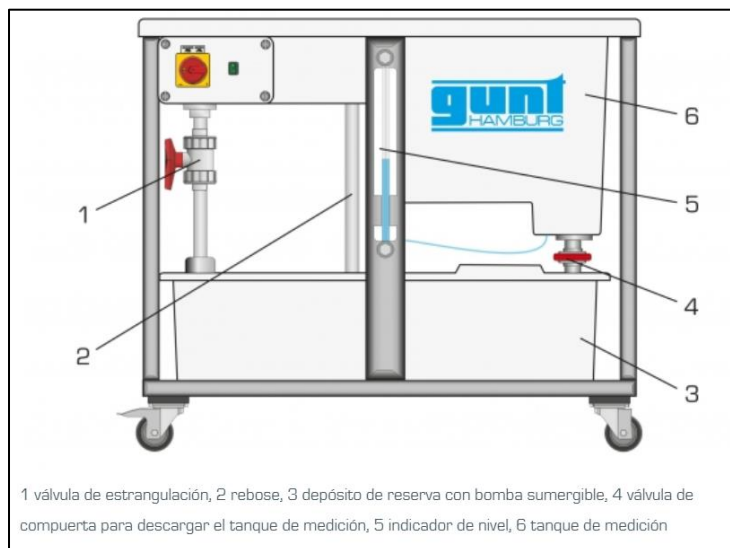
Ilustración 25. Descripción del equipo: Módulo básico para ensayos sobre mecánica de fluidos.
