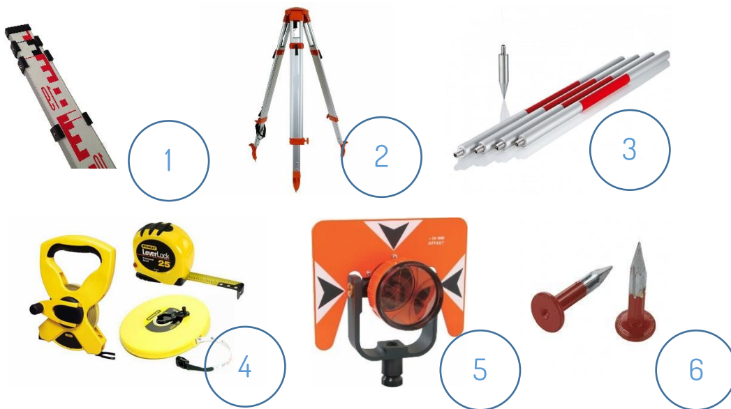
Ilustración 18 - Elementos para levantamiento topográfico: 1. Estadal; 2. Trípode; 3. Jalones; 4. Cintas métricas; 5. Miras; 6. Clavos topográficos.
