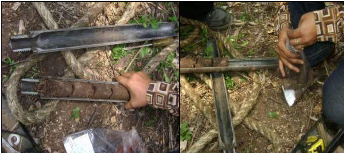
Fotografía 4.22 Obtención de muestras de suelo en campo, obtenida con la cuchara partida del equipo de penetración estándar a una profundidad de un metro
