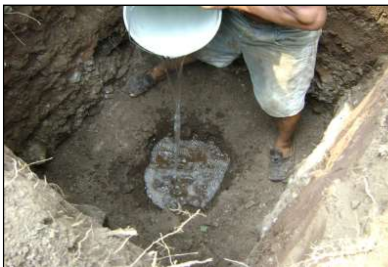
Figura 2.7: Llenado de agujero 24 horas antes de realizar las medidas
