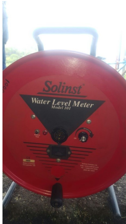
FIGURA 4. Sonda eléctrica para medición de profundidades (Mayo 2018). Esta sonda puede medir hasta 50 m de profundidad Propietario: Ministerio de Medio Ambiente y Recursos Naturales (MARN)
