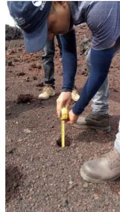
FIGURA 29. Medición de las dimensiones del pozo
