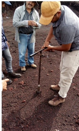
FIGURA 28. Excavación de pozo mediante barreno
