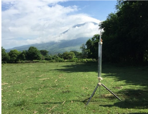
FIGURA 3. Instalación del Permeámetro de Guelph.
