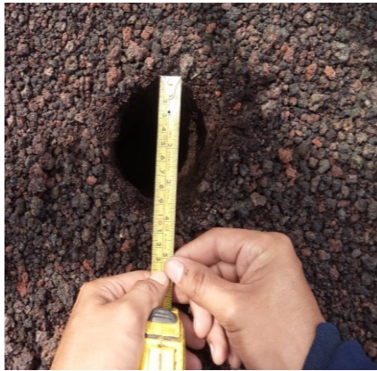
FIGURA 29. Medición de las dimensiones del pozo
