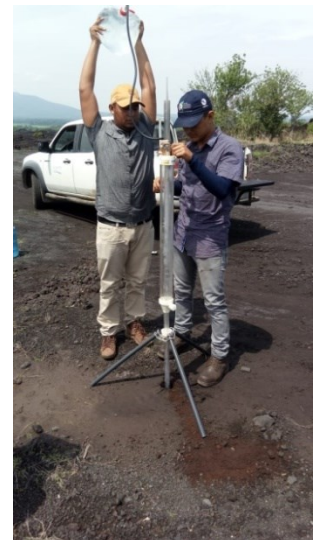
FIGURA 30. Montaje y llenado de depósitos de agua del permeámetro
