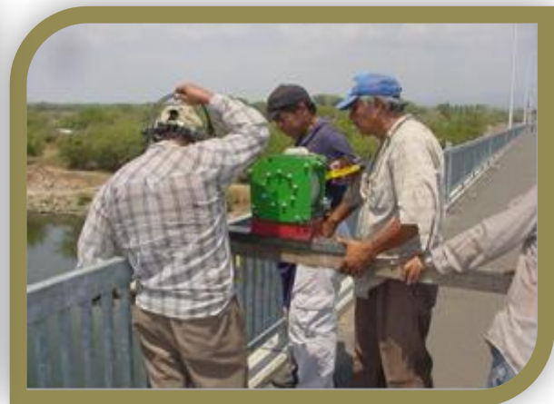
Fotografía 2.3.5.2.2 Medición de velocidad por suspensión con molinete.
