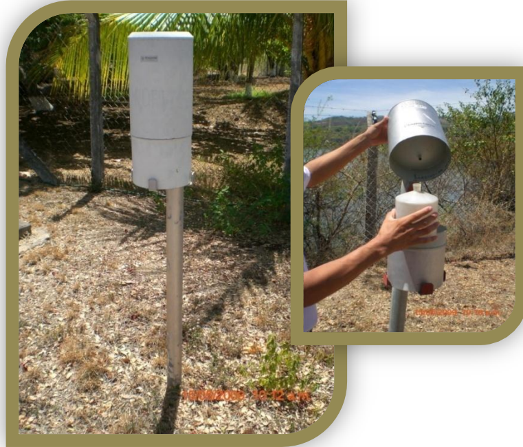
Fotografía 2.3.3.3.1 Pluviómetro Convencional, Estación N° 1 Corsain La Unión (SNET)
