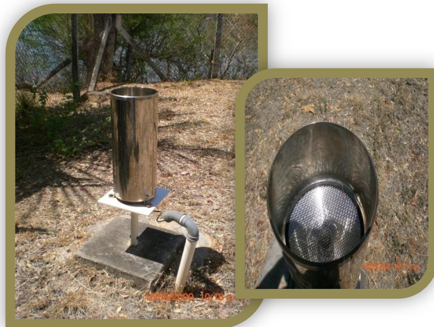
Fotografía 2.3.3.3.1 Pluviómetro Convencional, Estación N° 1 Corsain La Unión (SNET)
