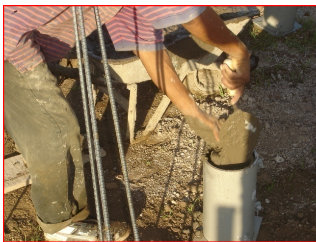
Fig. 4.115 Elaboración de especímenes de concreto.
