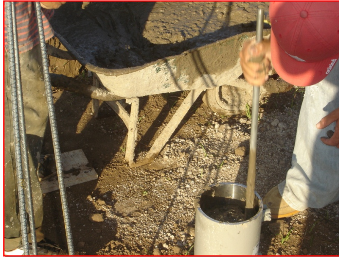
Fig. 3.67 Elaboración de espécimen de soleras de fundación.
