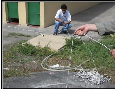
3. Se mide con una cinta métrica la profundidad a la que esta el agua (nivel estático); el cual es desde la varilla conductiva hasta la parte superior del brocal del pozo.
