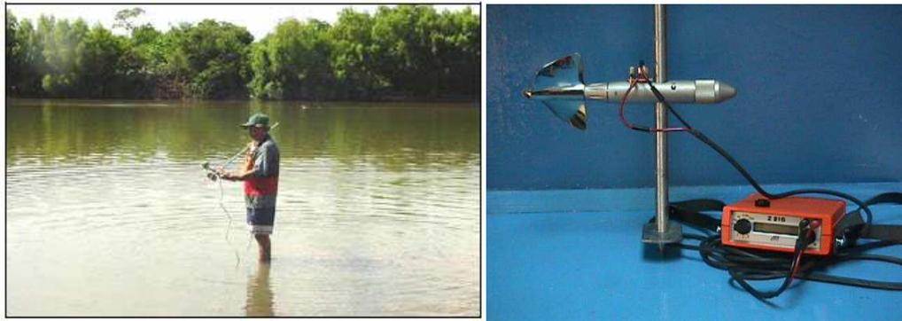
Figura 3.1.11 Medición de velocidades con Molinete
