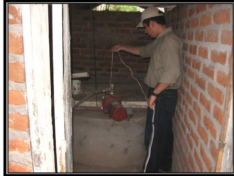
2. Cuando entra en contacto con el agua se enciende un foco en el otro extremo de la sonda, entonces se procede a colocar una marca en el punto de coincidencia de la sonda con el brocal del pozo.
