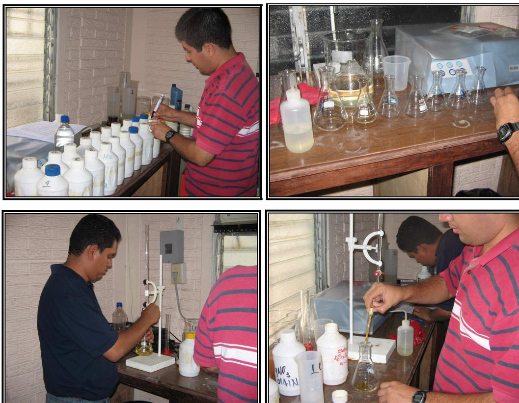
Figura 4.3.12: Realización de pruebas de laboratorio de la calidad del agua del acuífero.
