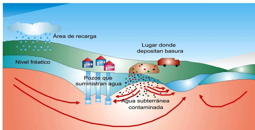
Figura 3.2.2 La contaminación del agua subterránea por desperdicios sólidos
