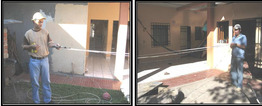
4. Se toma la altura del brocal del pozo, para tener la profundidad del agua desde la superficie.
