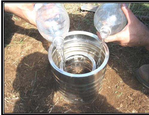
5. A medida que el nivel del agua en el anillo interior alcanza la marca de referencia superior, se registra el tiempo que transcurre desde que comenzó el ensayo.
