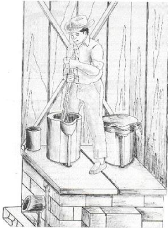
Fig. 5.15. El proceso de movido del contenido de las LAFS se debe realizar por lo menos una vez a la semana.
