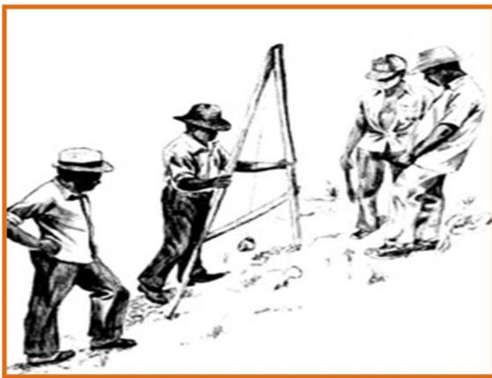
Para utilizarlo, una persona pone una pata del nivel en un punto fijo y mueve otra pata para arriba o para abajo, hasta que la plomada quede en el centro. Entonces, otra persona clava una estaca. Después, la persona que está operando el nivel mueve el aparato a la otra estaca y busca otra vez el nivel.
