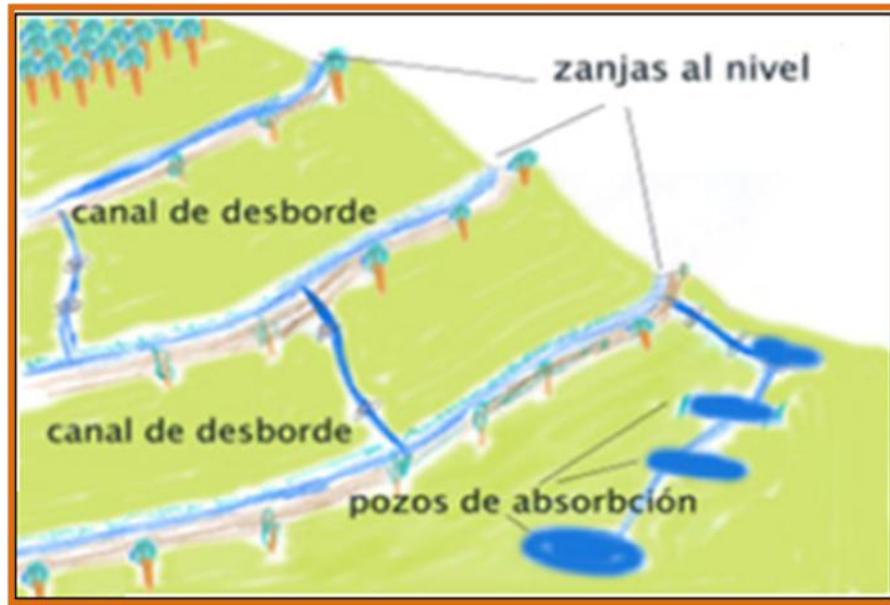
**Figura 2-37, Esquematzación del mecanismo de las zanjas de infiltración.**
