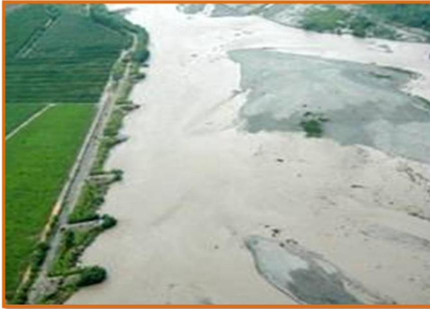
**Figura 2-22, Espigones construidos para protección de una carretera.**
