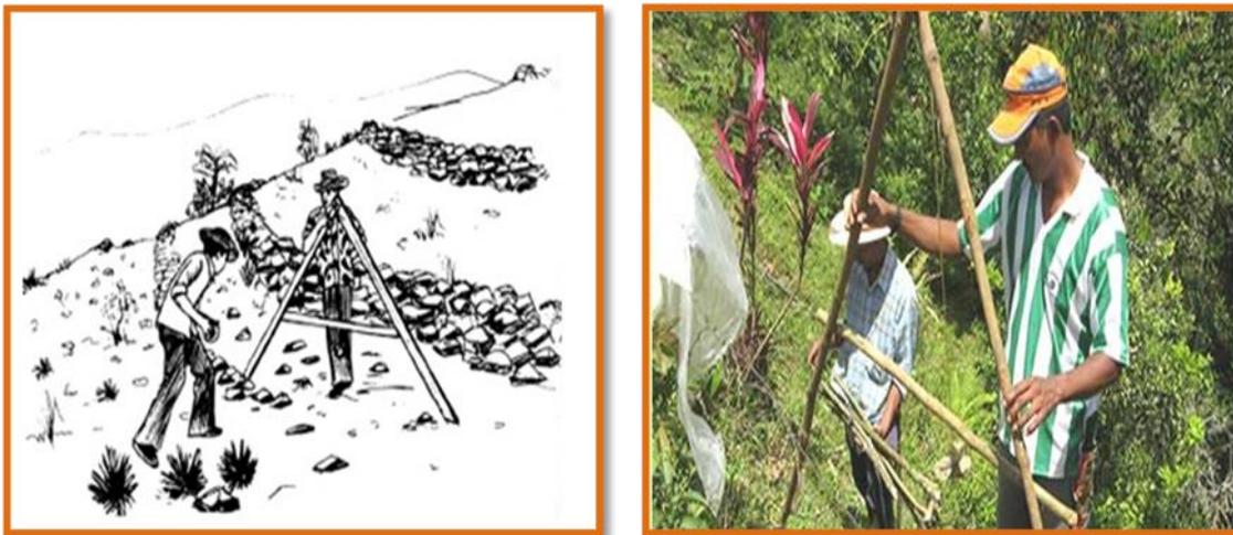
**Figura 2-36. Utilización del Aparato “A” para establecer niveles en las laderas.**
