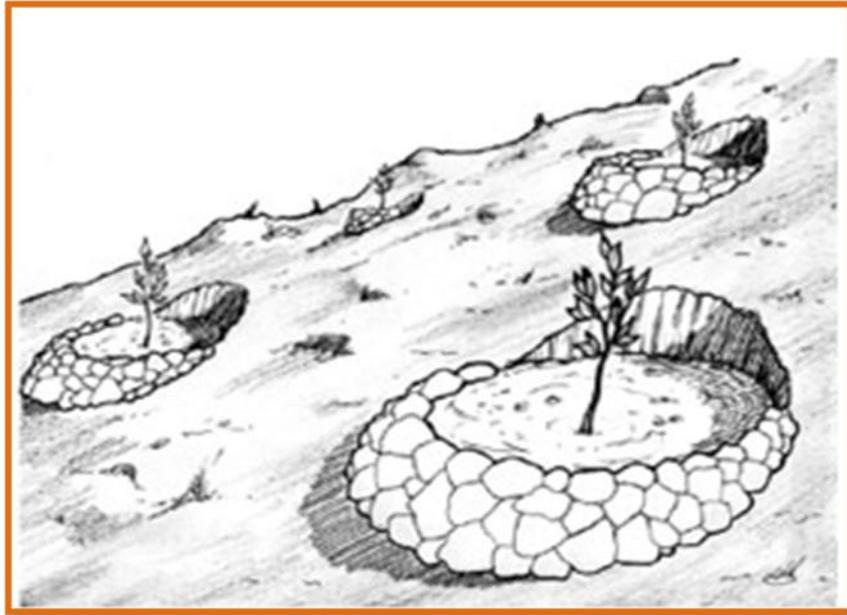
**Figura 2-46, Terrazas construidas en cada planta o árbol de forma individual.**
