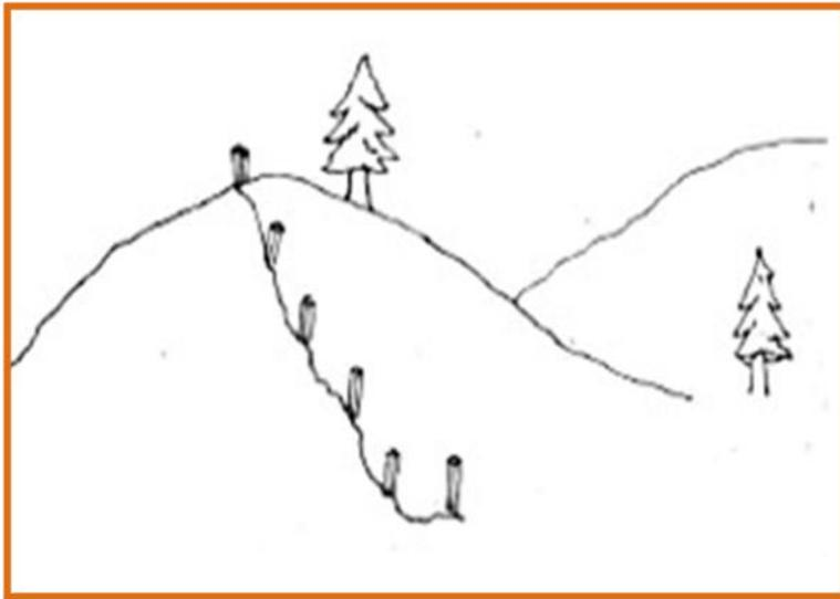
2. Tomando el "aparato A" a plomo, atravesamos la pendiente a la altura de las estacas que hemos puesto. Cada vuelta del marco «A» clavamos una estaca. Así determinamos los contornos.
