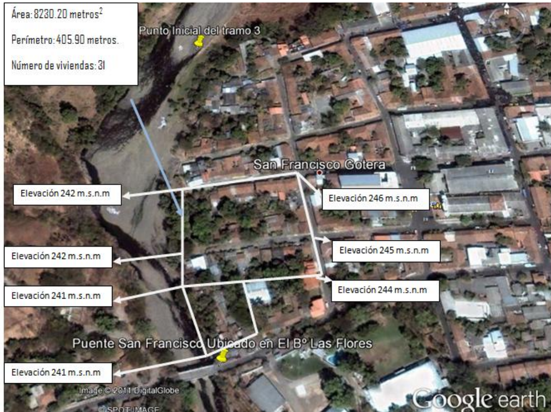
Figura 6.19 Ubicación de zona afectada por escorrentía superficial
