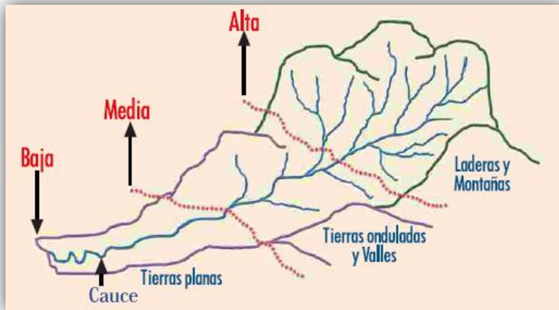
Figura 3.6 Partes de una cuenca hidrográfica
