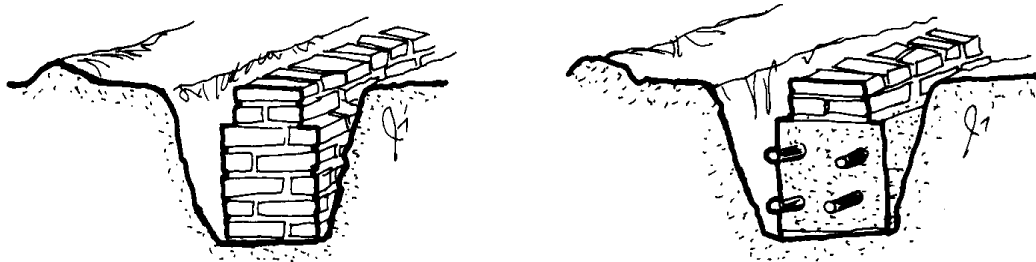
A. Solera de fundación de ladrillos.
