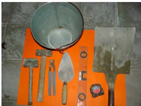
Herramientas y equipo empleados para preparar y pegar ladrillo de piso.
