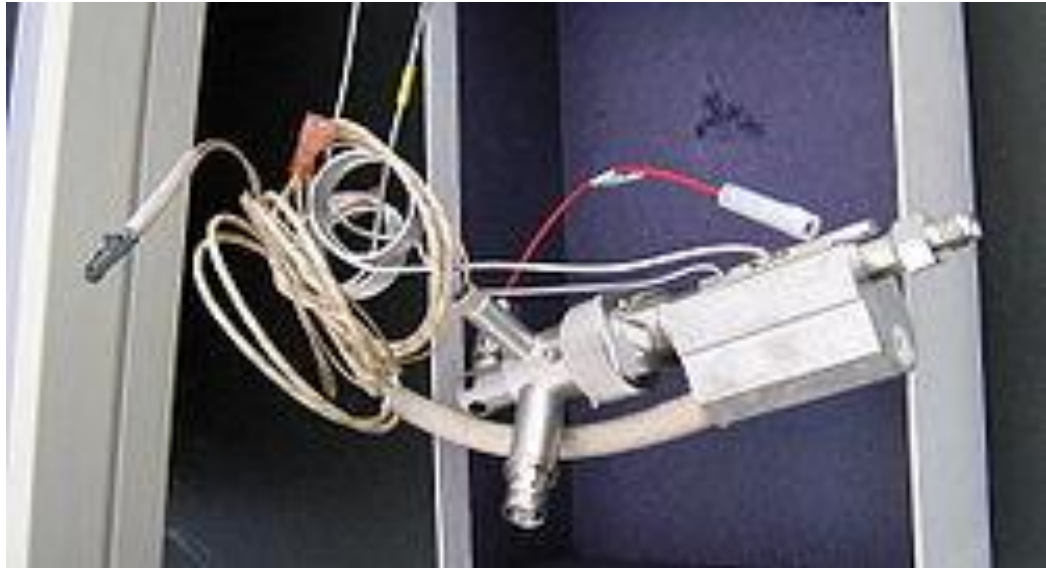
Figura N° 15: Vista de un detector GC del tipo FID (desmontado)
