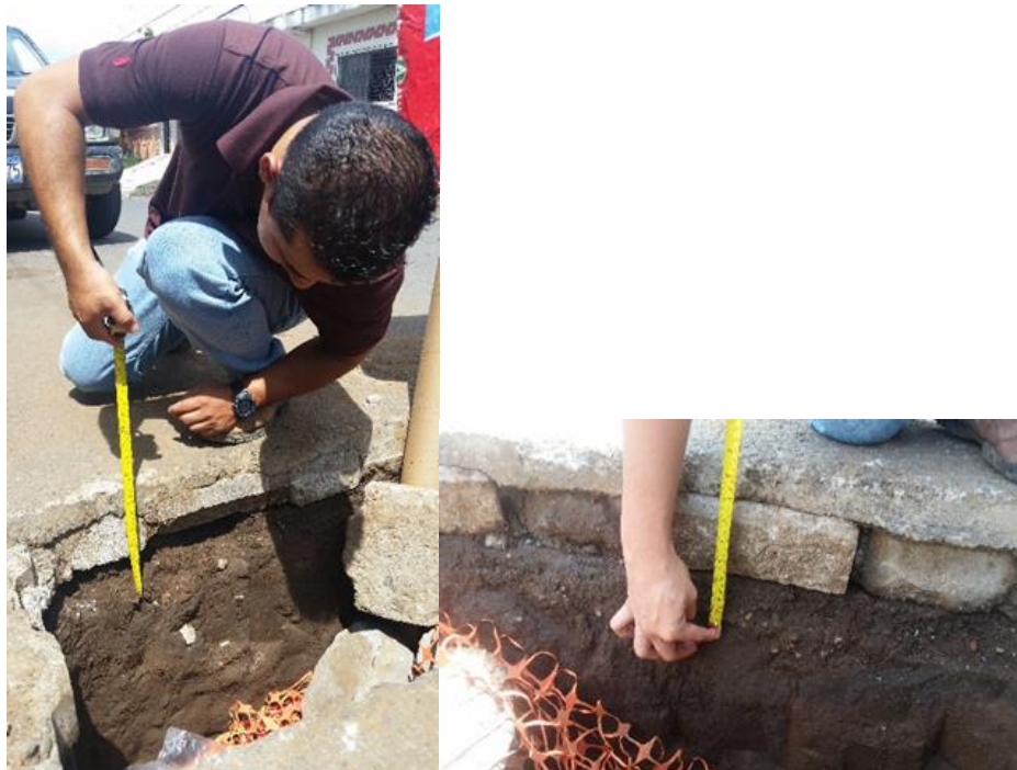
Figura 21. Medicion de espesores de capas
