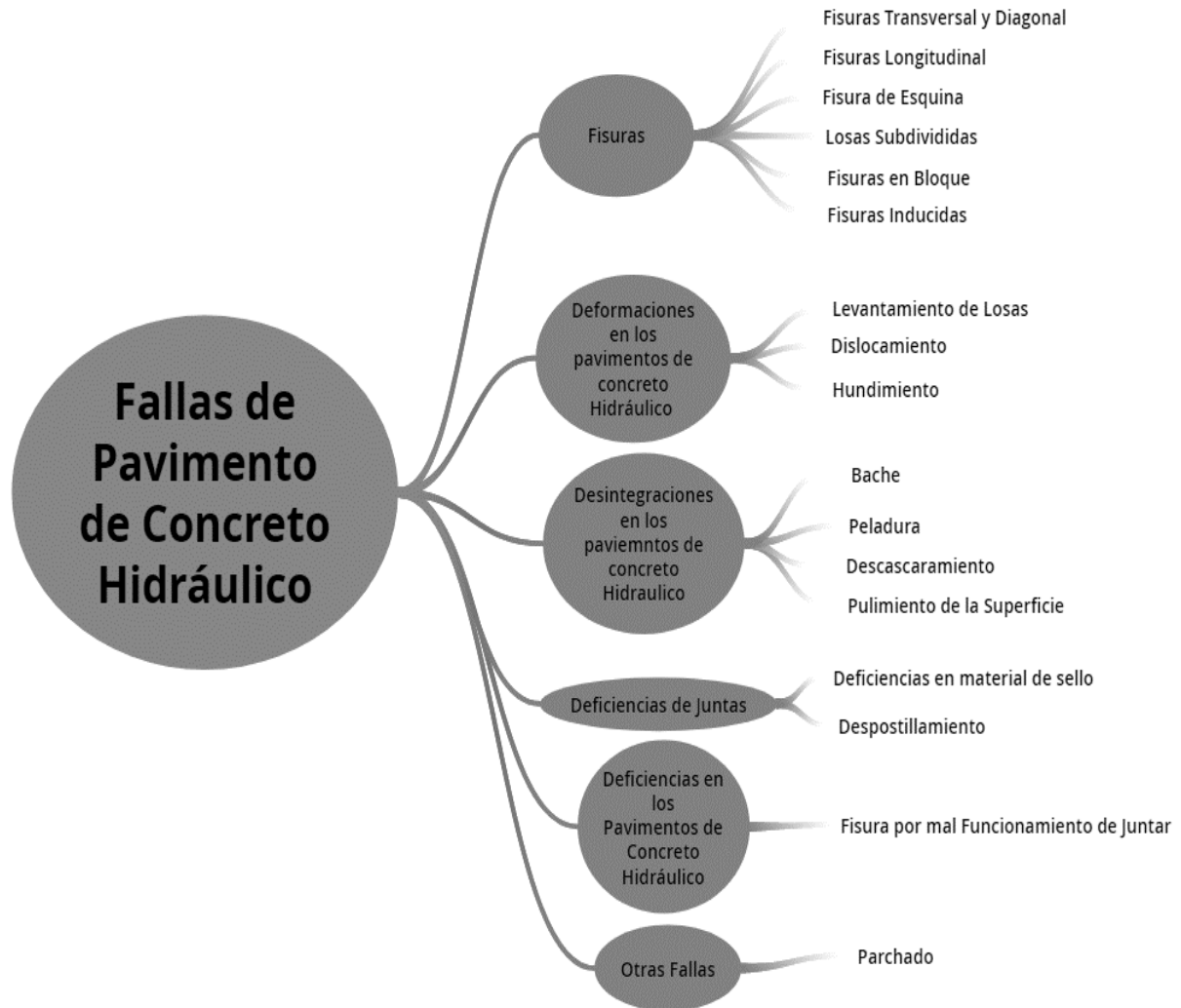
Figura 16. Fallas en Pavimentos de Concreto Hidráulico
