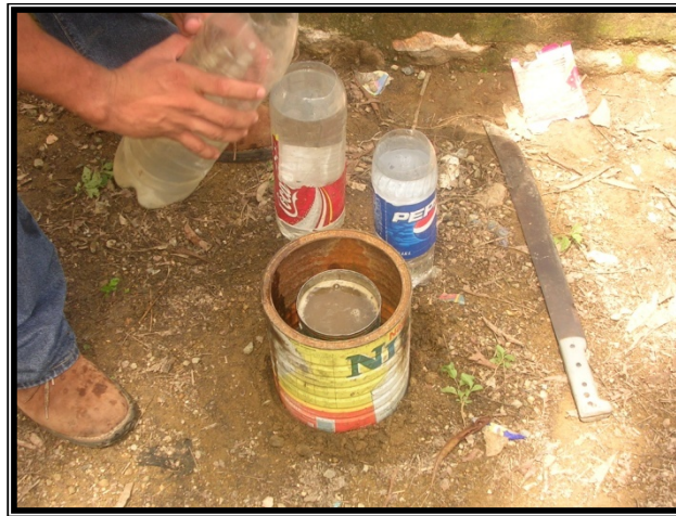
FIGURA 3.4.3.1.3.3: Abastecimiento de anillos durante pruebas.
