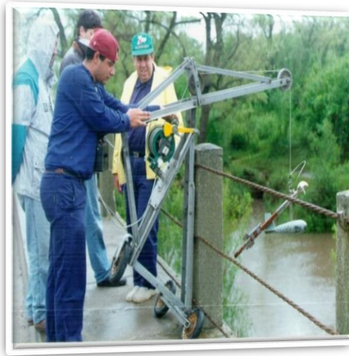
FIGURA II.3.5.1: MOLINETE POR SUSPENSIÓN DESDE UN PUENTE.
