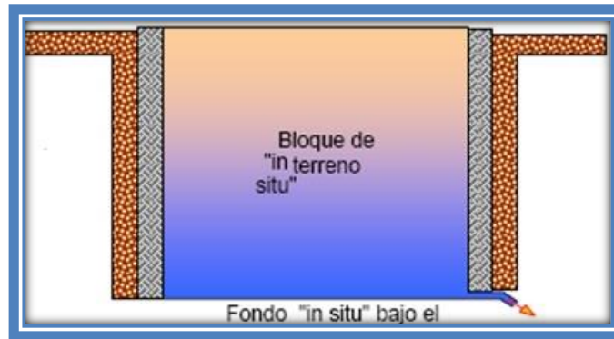
FIGURA II.3.4.2: INSTALACIONES DE LISIMETRICO MONOLITICO.
