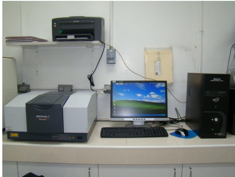
Figura N°28 Aparato de Espectrofotometría Infrarroja de transformada de Fourier, con el ordenador que contiene el programa IR-RESOLUTION, en el laboratorio Físicoquímico de Aguas
