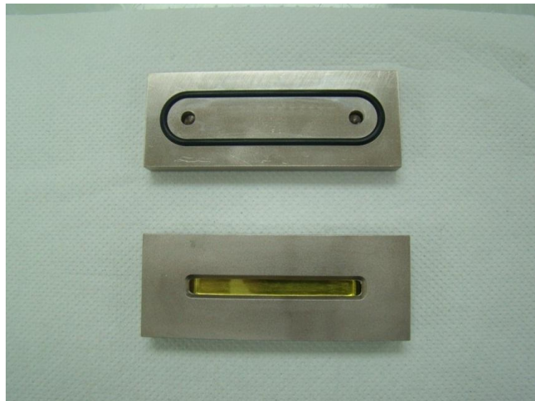
Figura N°31 Celda de Reflectancia Total Atenuada en la que se realizaron los análisis de Margarinas
