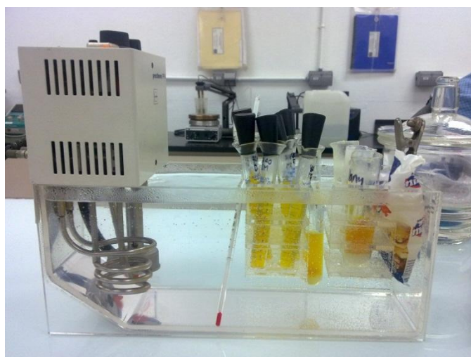
Figura N° 37 Tratamiento de muestras en el baño de María Precitherm PFV
