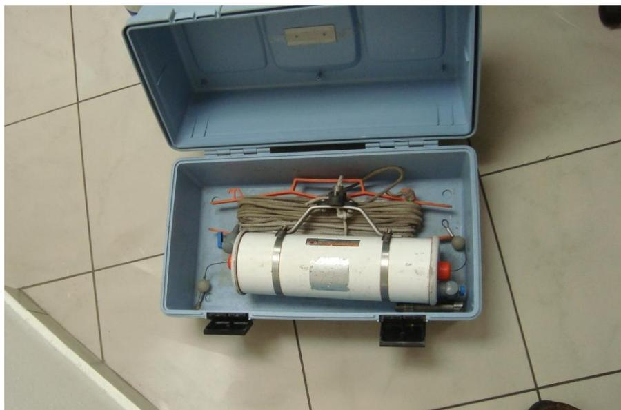
**Figura 3.7:** Revisión y verificación de equipos de muestreo, Botella de Van Dorn.
