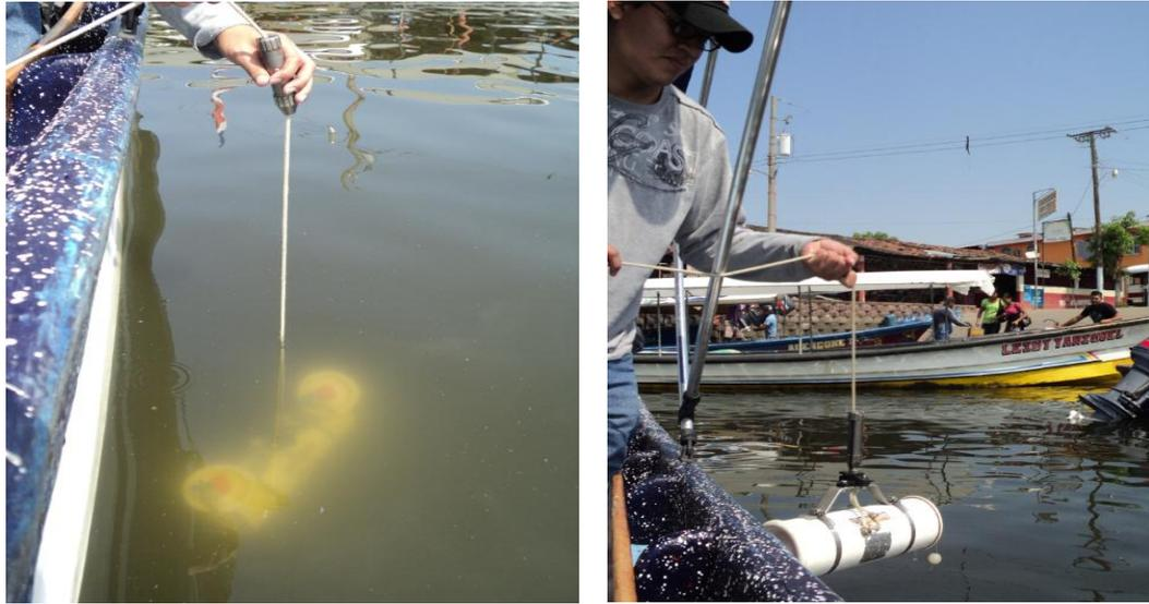
**Figura 3.10:** Obtención de la muestra utilizando la botella de Van Dorn.
