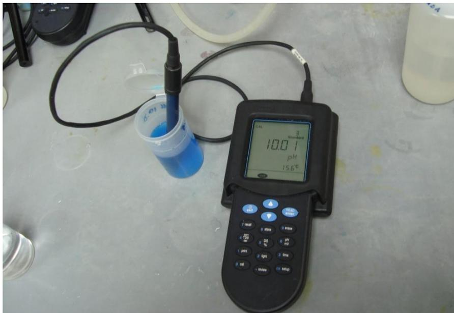
**Figura 3.6:** Revisión, verificación y calibración del equipo de medición multiparámetros.
