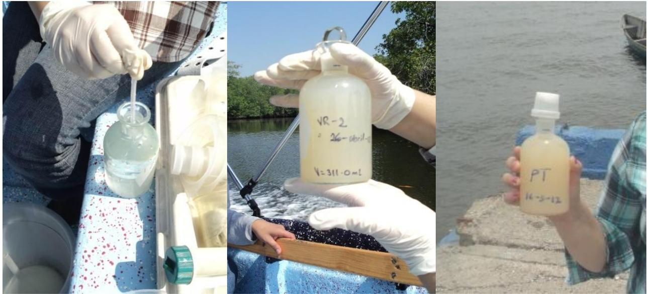
**Figura 3.18:** Método Winkler para la determinación de OD.
