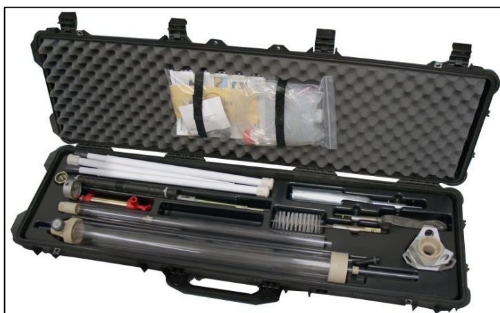
Figura 3.4. Izq.: Kit para el ensamble del Permeámetro de Guelph 5 . Der.: Armado y toma de lecturas con el Permeámetro de Guelph.
