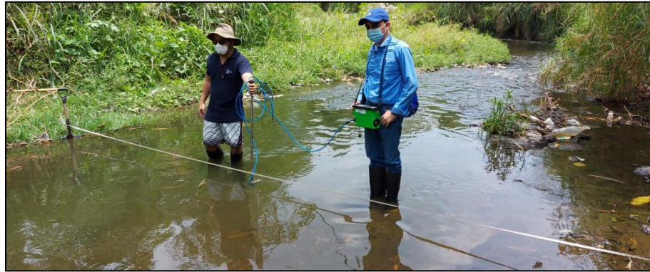
Figura 3.5. Aforos en el cauce principal del Río Colón.
