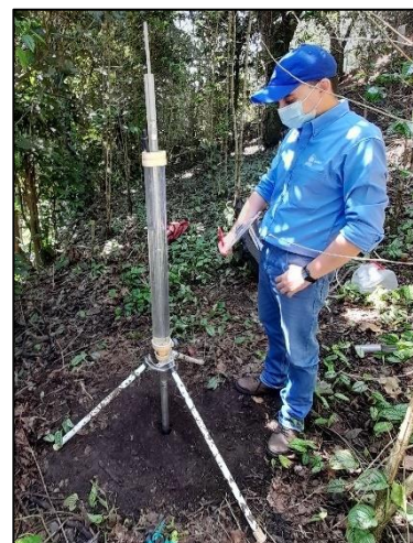
Figura 3.4. Izq.: Kit para el ensamble del Permeámetro de Guelph 5 . Der.: Armado y toma de lecturas con el Permeámetro de Guelph.
