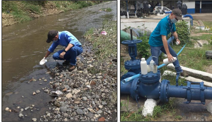
Figura 3.2. Muestreo de parámetros FQ en fuentes de agua dentro de la microcuenca del Río Colón.
