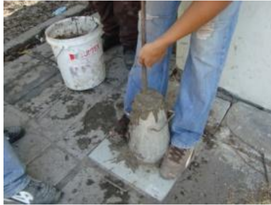
Imagen 3.5. Prueba de revenimiento, varillado
