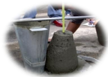
Imagen 2.9. Prueba de revenimiento a concreto
