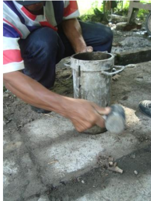
Imagen 3.10. Golpeo de paredes exteriores para evitar burbujas de aire en el concreto
