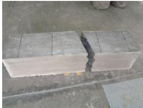
Imagen 3.19. Vigueta después de falla
