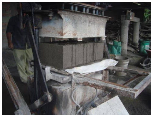
Imagen 6.8. Bloques recién elaborados con mortero
