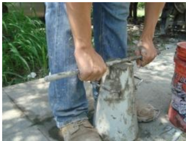
Imagen 3.7. Prueba de revenimiento, alisando superficie de concreto
