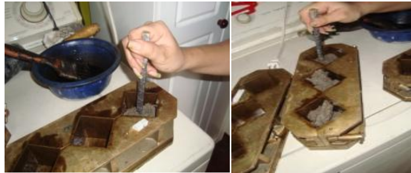
Imagen 4.4. Secuencia fotográfica de llenado de moldes de cubos de mortero.
