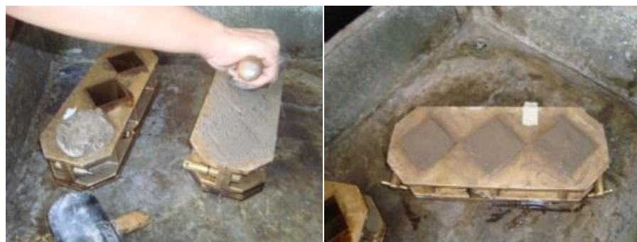
Imagen 4.5. Secuencia fotográfica de llenado y enrasado de cubos de mortero.
