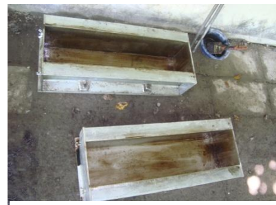
Imagen 3.12. Engrasado de moldes prismáticos
