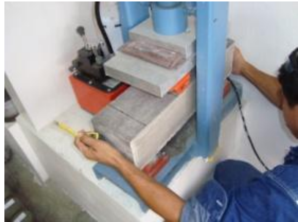
Imagen 3.18. Colocación de vigueta en máquina para la flexión
