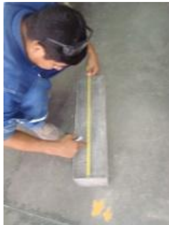
Imagen 3.17. Medición de los tercios medios en viguetas
