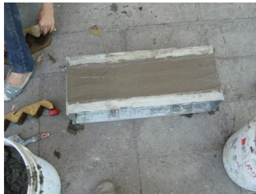
Imagen 3.13. Moldes prismáticos terminados
