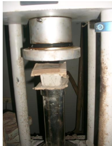
Imagen 4.11. Cubo de mortero después de falla.
