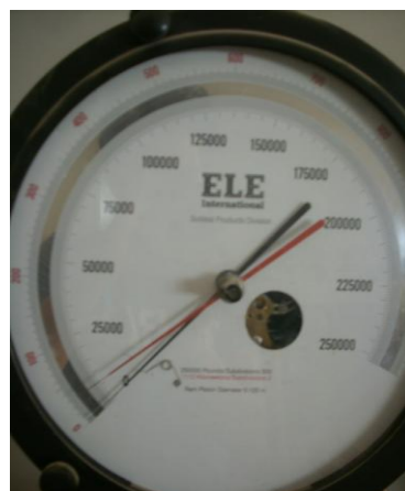
Imagen 4.10. Aplicación de carga a cubo de mortero.
