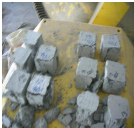
Imagen 4.12. Cubos de mortero después de falla.
