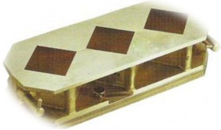
Imagen 2.13. Moldes para la elaboración de cubos de mortero
