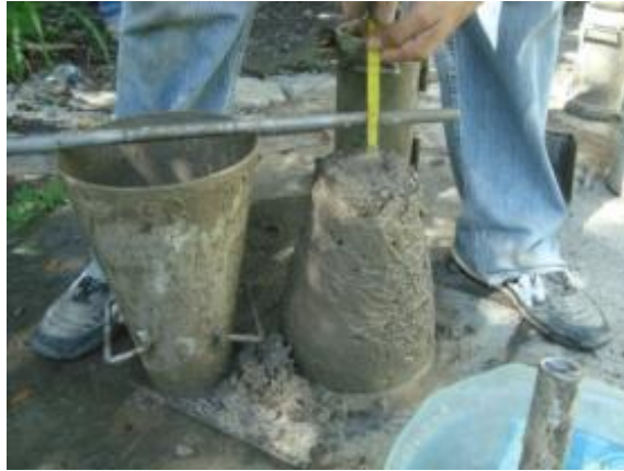
Imagen 3.7. Prueba de revenimiento, medición de revenimiento
