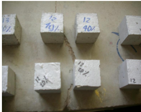
Imagen 4.7. Cubos antes de ensayo a la compresión.
