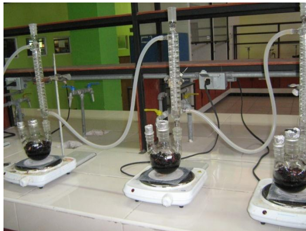
Fig. N°18 Extracción Etanólica a 90°
