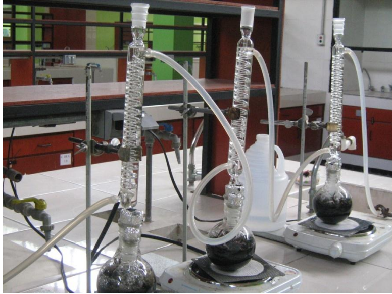
Fig. N°17 Extracción por Método de Reflujo
