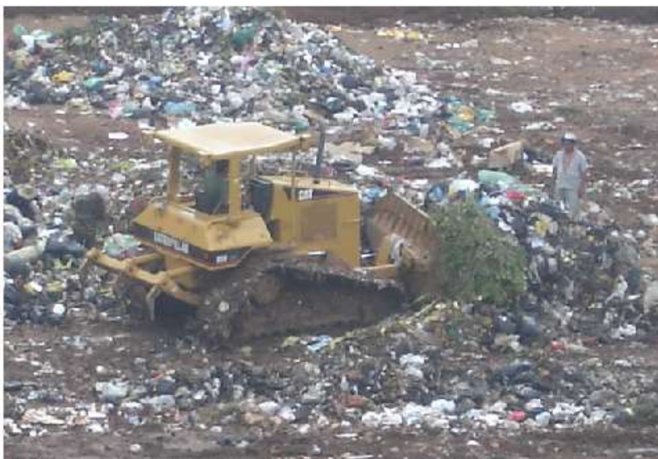
Fotografía 4.6 Maquinaria D5N propiedad del relleno sanitario.
