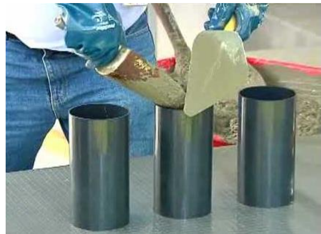
Figura 4. Prueba con cilindro. Fuente: https://images.app.goo.gl/kLRyLgfJ3MEgsC1G8
