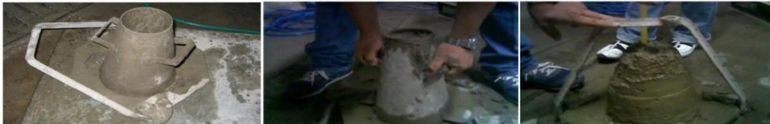
Figura 5. Pruebas de revenimiento. Fuente: https://www.uca.edu.sv/mecanica-estructural/materias/materialesCostruccion/quiasLab/ensavoConcretoFresco/REVENIMIENTO.pdf
