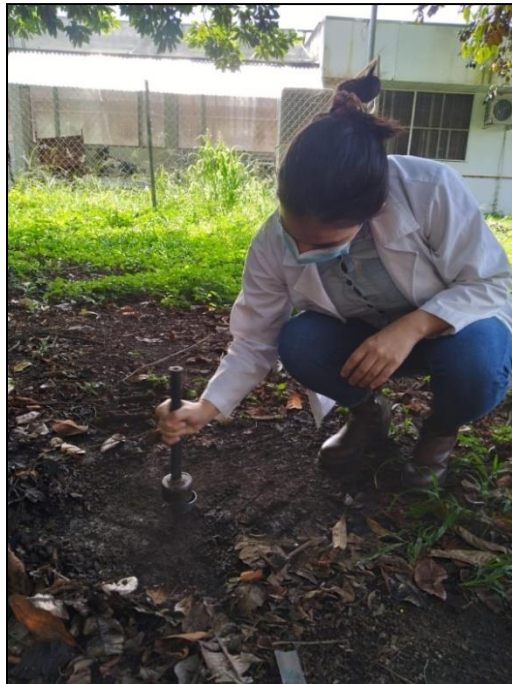
Anexo 22. Toma de muestra de suelo con cilindro para determinar densidad aparente
