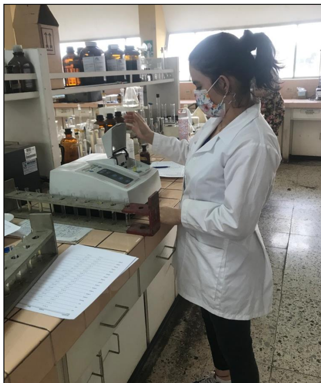
Anexo 20. Realización de lecturas de fosforo en el equipo colorimétrico
