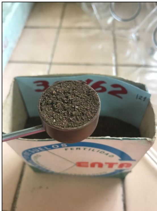
Anexo 7. Toma de muestras para la determinación de pH.
