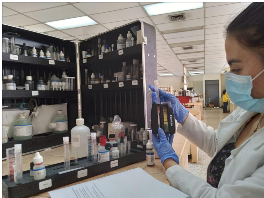
Anexo 24. Determinación de pH con el kit de análisis de suelos
