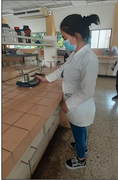
Anexo 21. Pesaje del cilindro con la muestra de suelo
